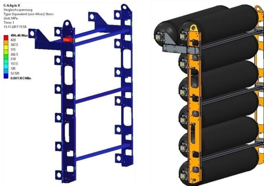
Abbildung 41: Nachweis der Festigkeit der Tankanbindung nach EG 79/2009
