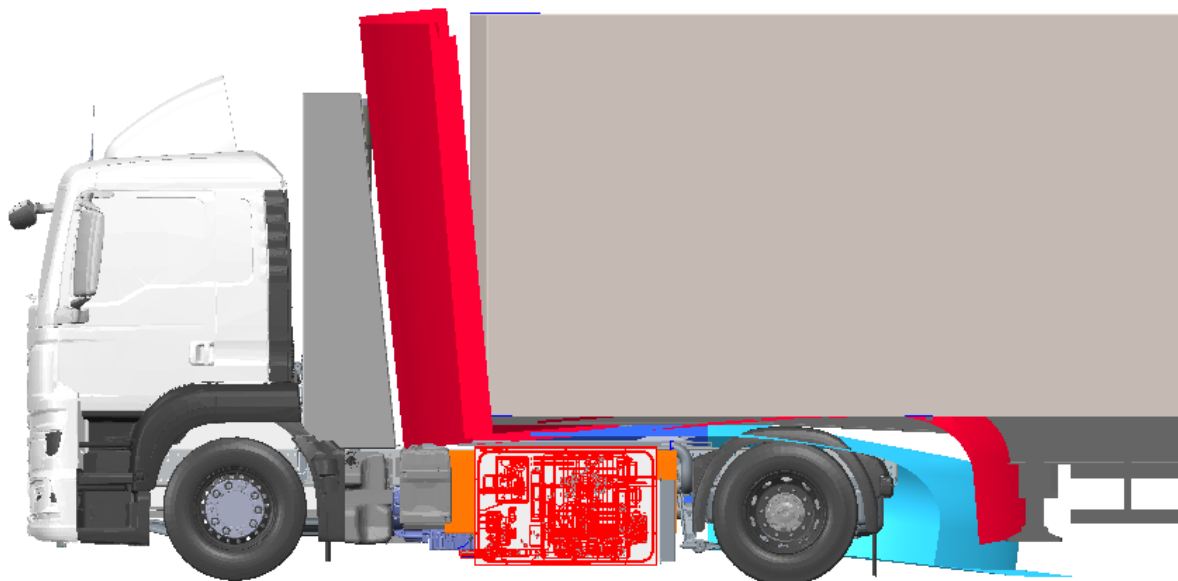
Abbildung 74: Aktuelles Brennstoffzellen-System im Bauraum einer seitlichen Batterie
