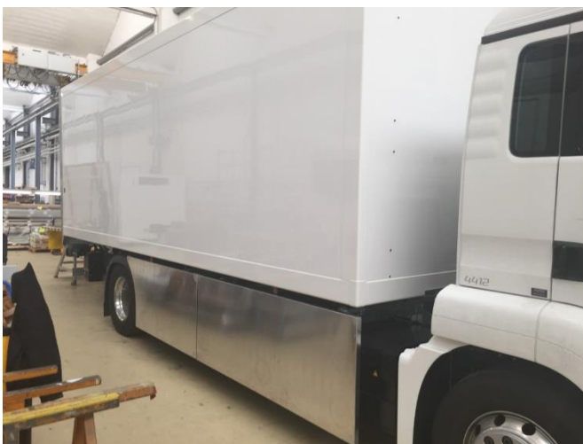
Abbildung 26: Montage von Kühlkoffer und Unterfahrschutz bei Frech-Hoch
