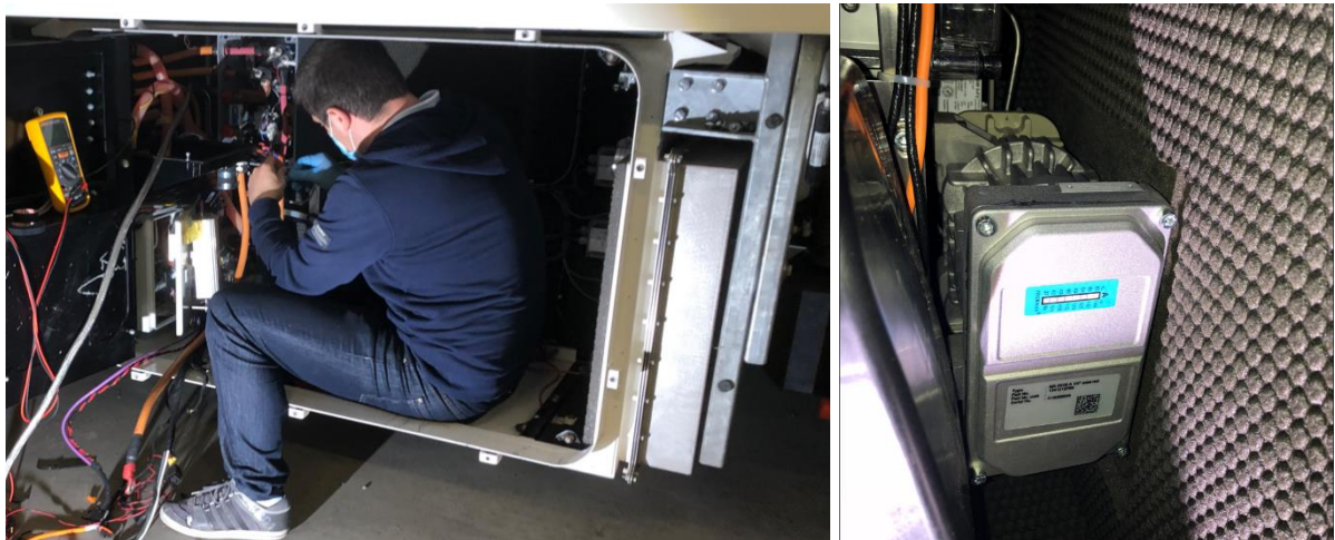
Abbildung 63: Illustration der nicht immer sehr ergonomischen Platzverhältnissen und der Millimeterarbeit zwischen Rezirkulationspumpe und der Brennstoffzellen-Box.
