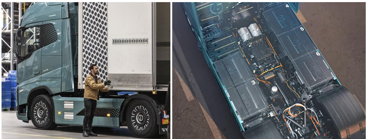
Abbildung 67: Volvo FH electric: Batterien zwischen den Achsen, zentraler Motor mit Kardanwelle (Bilder Volvo)
