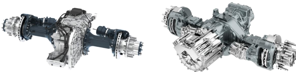
Abbildung 71: Angebotene Achsen von Allison (links) und Dana (rechts) für schwere LKWs (Bilder Allison / Dana)
