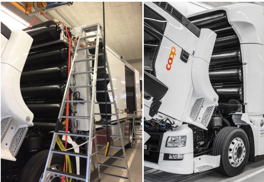
Abbildung 30: Montage des Tankracks am Koffer und komplett verbautes Tanksystem
