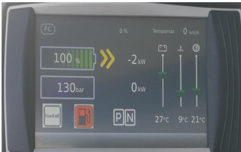
Abbildung 23: Display in der Fahrerkabine zur Bedienung des Brennstoffzellen-Systems
