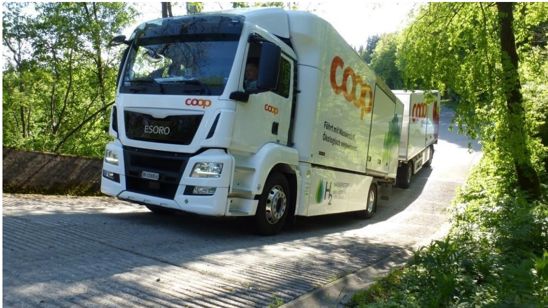
Abbildung 44: Erfolgreicher Anfahrversuch, Steigung: 30%, Fahrzeuggewicht: 35t.
