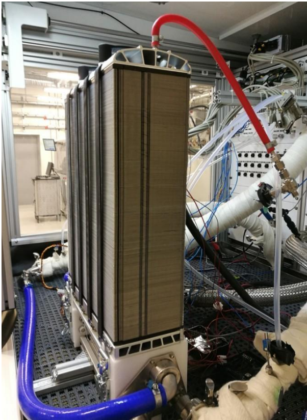
Abbildung 31: Der Brennstoffzellenstapel auf dem Prüfstand bei Powercell
