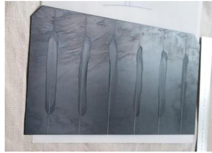
Abb. 31: Links: Kombination des Ansatzes aus Gruppe 6 mit zusätzlichen Folienstreifen von ca. 2.5 cm Breite an die Stösse der Zellenkanten angeschoben, um die die Freiräume zwischen Zelle und Auflage (Schindeleffekt) zu minimieren. Rechts: Verringerung des Lötbereiches durch eingeschränktes Aufbringen von Flussmittel (gezeigt: Testmittel mit Fluxspuren).
