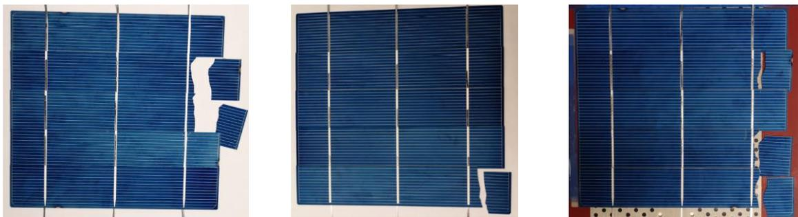
*Abb.3: Die Brüche traten zunächst überwiegend auf einer Seite auf und entstanden aufgrund der mechanischen Belastung durch die Lötköpfe in Bereichen mit Überlapp.*
