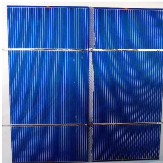
*Abb. 14: Einbringen von Einbettmaterial in den Überlappbereich zwischen den Bändchen beim Stringaufbau, um den direkten Kontakt der Zellenkanten zu verhindern und die Hebelwirkung zu verringern.*
