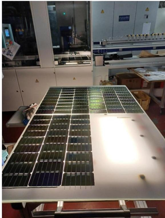
*Abb. 32: Auflegen der Strings auf das frontseitige Glas und die frontseitige POE-Lage. Bei diesem Arbeitsschritt wurde auch das Verschalten der Strings ausgeführt.*
