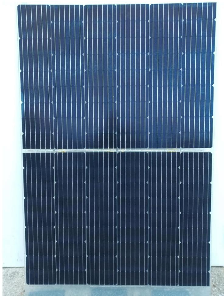
*Abb. 33: Bifaziales Grossmodul aus PERC-Zellen welches, basierend auf den Ergebnissen der Vorversuche mit Mini-Modulen, hergestellt wurde.*
