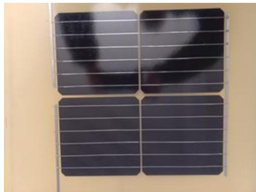
Abb. 32: 4-zelliges Referenzmodul mit klassischer Verschaltung zum Vergleich mit den Mini-Modulen aus jeweils 8 Halbzellen.
