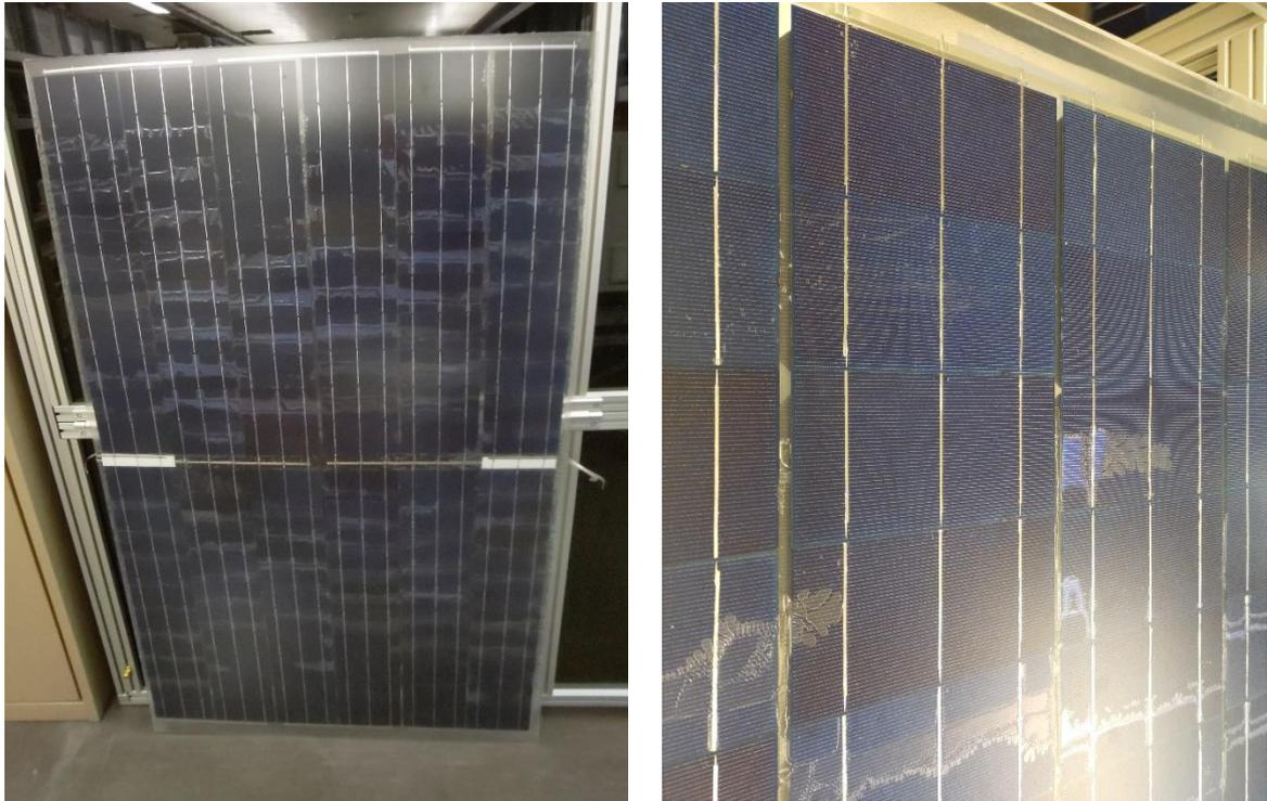
*Abb. 17: Durch überlappendes Lötten aus 120 Halbzellen hergestelltes Grossmodul. Probleme bei der Lamination verursachten eine teilweise unzureichende Haftung des Einbettmaterials auf der Zellenoberfläche.*
