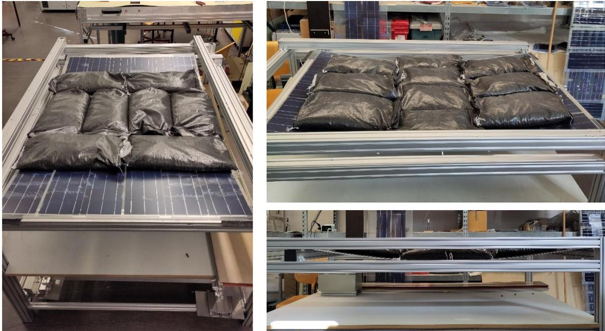
Abb. 19: «Mechanical Load»- Test mit dem in Abbildungen 17 und 18 gezeigten Modul. Das Gewicht wurde in Schritten von 20 kg erhöht. Das Maximalgewicht der Sandsäcke lag bei 260 kg. Hier wird die Belastung bei etwa 200 kg gezeigt.
