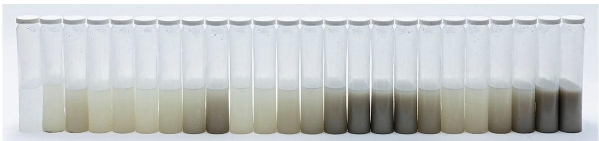
Abbildung 51: Serie von 24 Wasserproben aus dem Triebwasser des KW Susasca vom 06.-22.08.2020 (aus der Entnamekammer gepumpt, Feinsedimentpartikel durch Schütteln resuspendiert; Foto: VAW).
