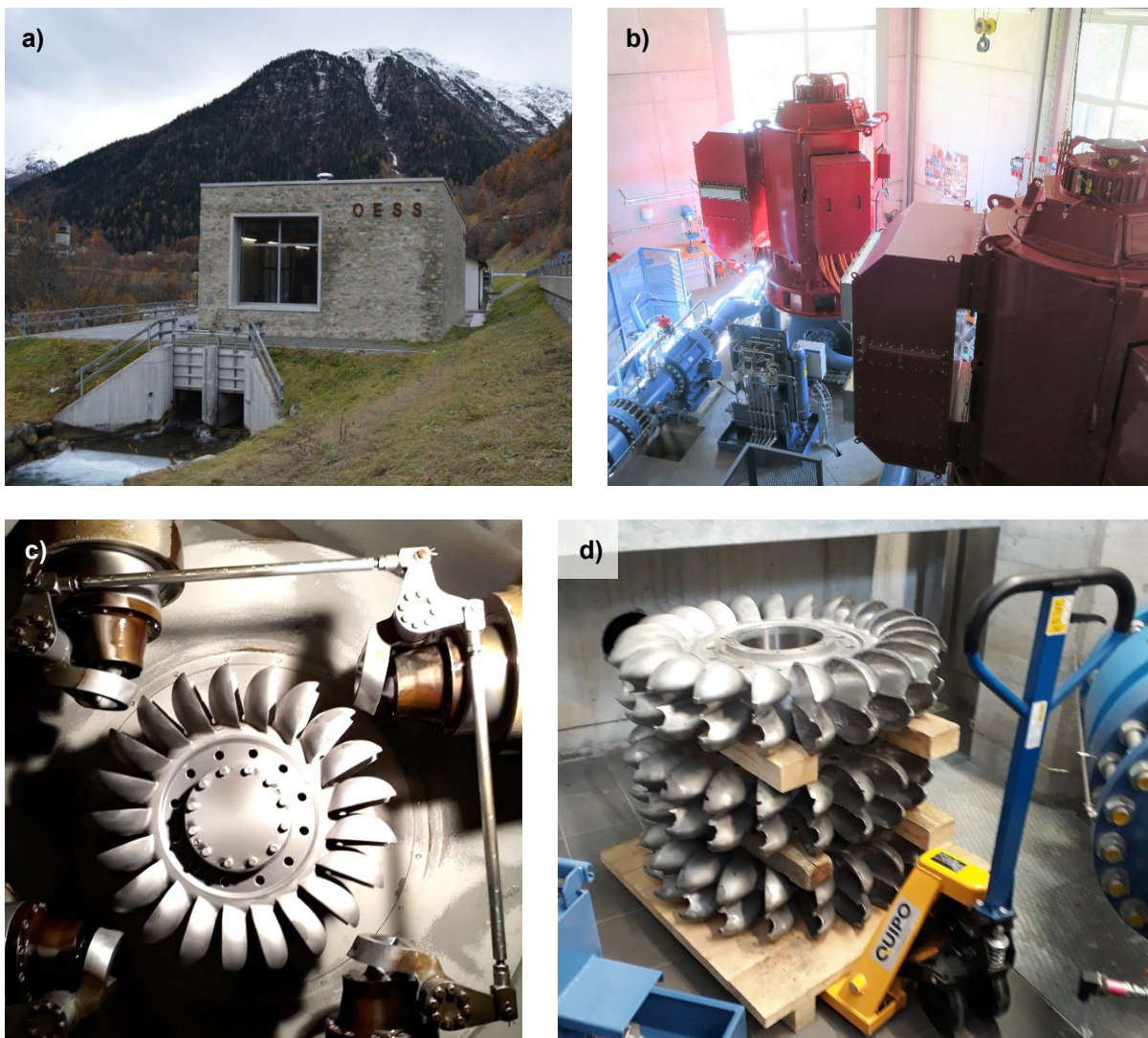
Abbildung 15: a) Zentrale des KW Susasca mit Unterwasserkanal zum Inn (09.11.2018), b) Blick auf die zwei Maschinengruppen, c) Blick von unten an ein Pelton-Laufrad und vier Düsen mit Strahlableitern sowie d) abgenutzte ausgebaute Laufräder (Fotos VAW).
