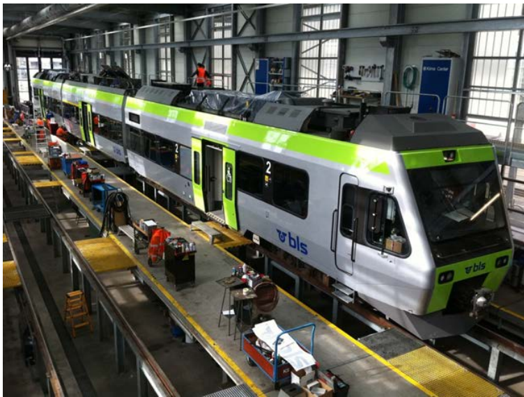
Abbildung 37. Triebzug RABe 525 NINA 006 in der BLS-Werkstätte Bönigen. Fahrgastraum mit 36 Stk. Wärmedämmfenstern mit hoher Durchlässigkeit für Mobilkommunikation, eingebaut anlässlich Refit-Projekt im Oktober 2015. Foto: BLS Ch. Isenschmid.
