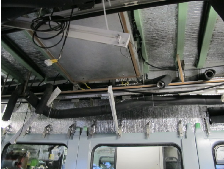
Abbildung 78. Fertige Wärmedämmung des Dachs im Niederflurabteil des Endwagens ET1, bei demontiertem Decken-Lüftungskanal. In der Bildmitte ist der Zugangsdeckel zu Hauptschalter, Primärstromwandler und Primärspannungswandler sichtbar.
