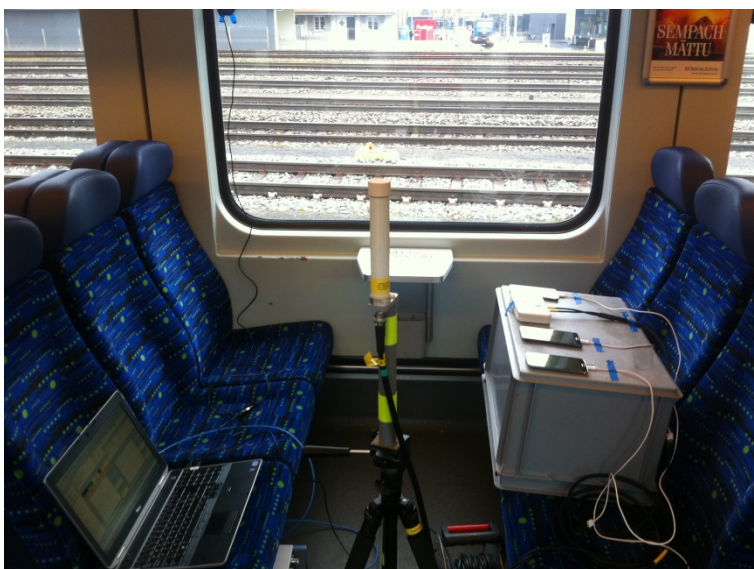
Abbildung 39. Messausrüstung von SWISSCOM für Messung von Signalstärke sowie Datenübertragungsrate für die Mobilfunkstandards 3G und LTE während den Messfahrten am 1. März 2016. Foto BLS Ch. Isenschmid.
