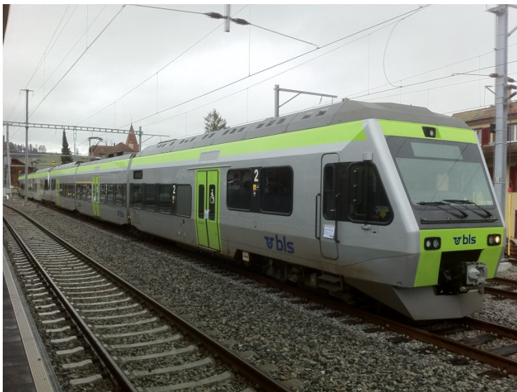
Abbildung 40. Triebzüge RABe 525 NINA 005 (vorne) mit verbesserter Wärmedämmung und 006 (hinten) mit herkömmlicher Wärmedämmung, anlässlich der Heizversuche vom 20./21. Januar 2018 auf Gleis 4 im Bahnhof Huttwil. Foto: BLS Ch. Isenschmid.
