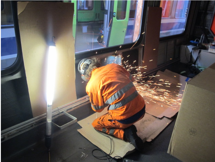
Abbildung 52. Entfernen der bisherigen Halterungen für die Seitenwandtische. Foto: ECOTRANS Peter Wüst, 12.10.2017.
