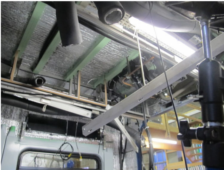
Abbildung 77. Fertige Wärmedämmung im Niederflurabteil beim Wagenübergang des Endwagens ET2. Erkennbar ist die Wärmedämmung bei der Stirnwand des Wagenkastens, analog der Wärmedämmung der Seitenwand. Foto: ECOTRANS Peter Wüst, 14.11.2017.
