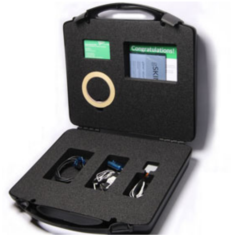
Abbildung 22. U-Wert-Messgerät GREENTEG gSKIN KIT-2615C. Quelle: http://shop.greenteg.com .
