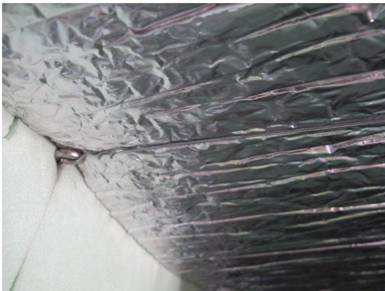
Abbildung 35. Abspannung des Stahldrahts am Dachspriegel am Ende des Fahrgastabteils mittels Schraubenöse, mit Wärmedämmung am Dachspriegel und an der Decke. Foto ECOTRANS Peter Wüst, 13.10.2017.
