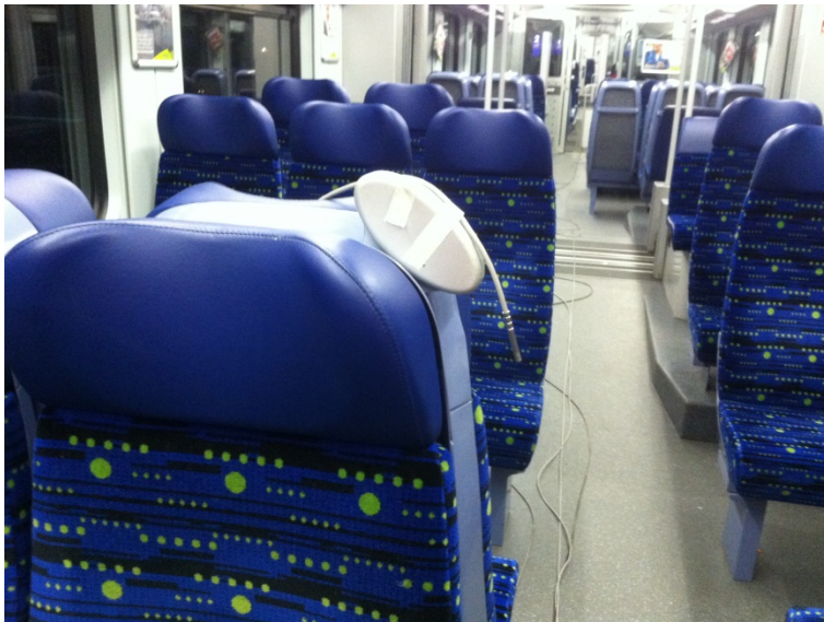
Abbildung 41. Temperaturfühler zu Datenlogger QUANTUM X für Innentemperatur im Fahrgastraum des Triebzugs RABe 525 NINA 006, auf einer Höhe von 1.1 m an den Fahrgastsitzen befestigt. Foto BLS Ch. Isenschmid.
