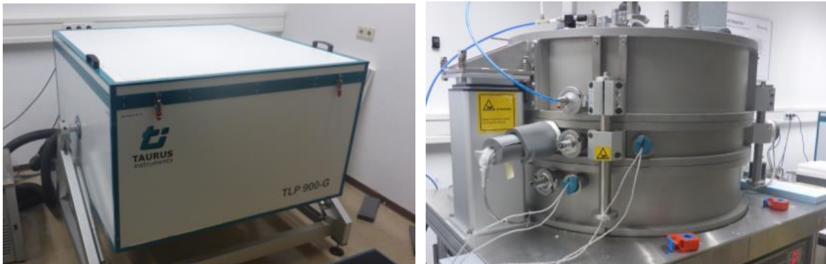
Abbildung 3: Messung der Wärmedämmung mit Berücksichtigung der Kondensationsfeuchtigkeit
