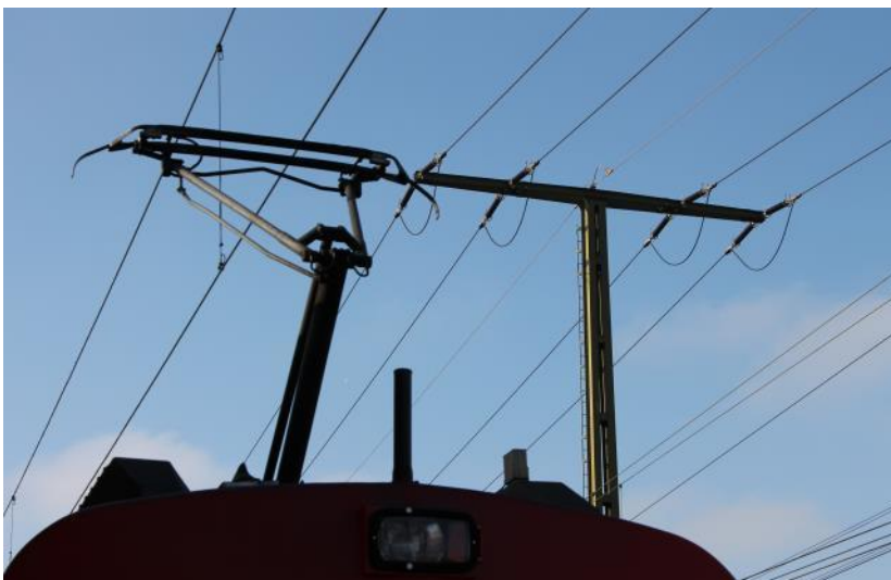
Abbildung 9: AB neben SBB – 1.5 kV-DC-Fahrleitung der Appenzeller Bahnen nahe der 132 kV-AC-Freileitung der Schweizerischen Bundesbahnen in Gossau (04.12.2016, Foto: Steffen Schranil)
