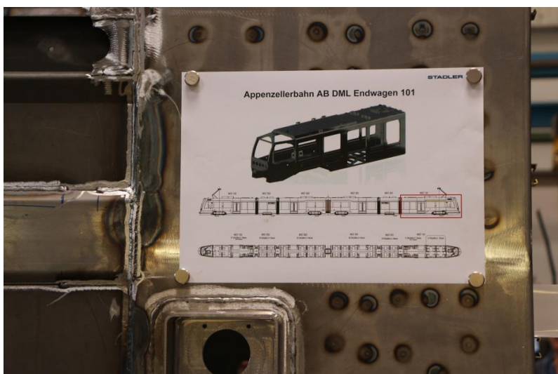
Abbildung 25: Rohbau eines DML-Endwagens im Stadlerwerk Bussnang (20.05.2017, Foto: Steffen Schranil)
