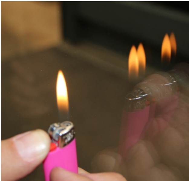
Abbildung 21: Untersuchung einer Verglasung mit IR-Reflexionsschicht (Glas F1 - Niederflurbereich)
