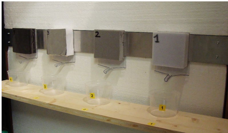
Abbildung 24: Prüfanordnung zur Ermittlung der Kondensatmenge
