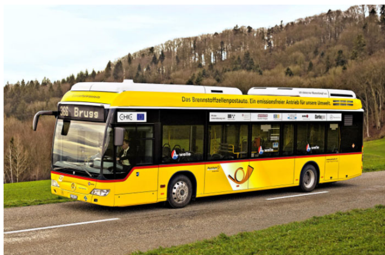
Figure 13 : car postal fonctionnant grâce à de l'hydrogène et une pile à combustible 30
