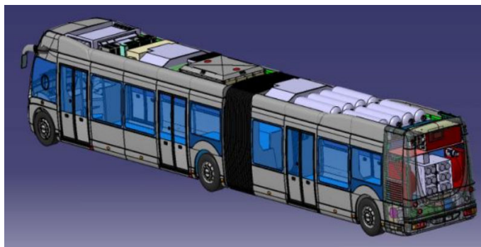
Figure 21 : la complexité et le volume de l'équipement nécessaire au bus à hydrogène Phileas de 18 [m] 134
