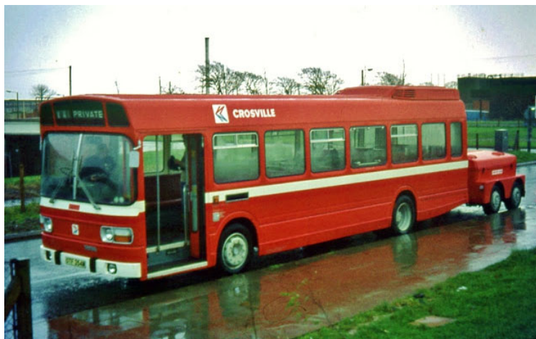
Figure 6 : bus modifié pour fonctionner avec des batteries dans les années 70 46
