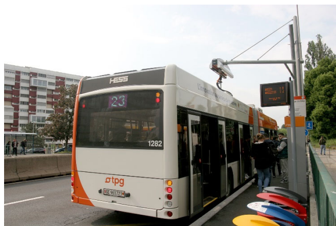
Figure 7 : bus TOSA et sa station de recharge rapide à l'arrêt 50
