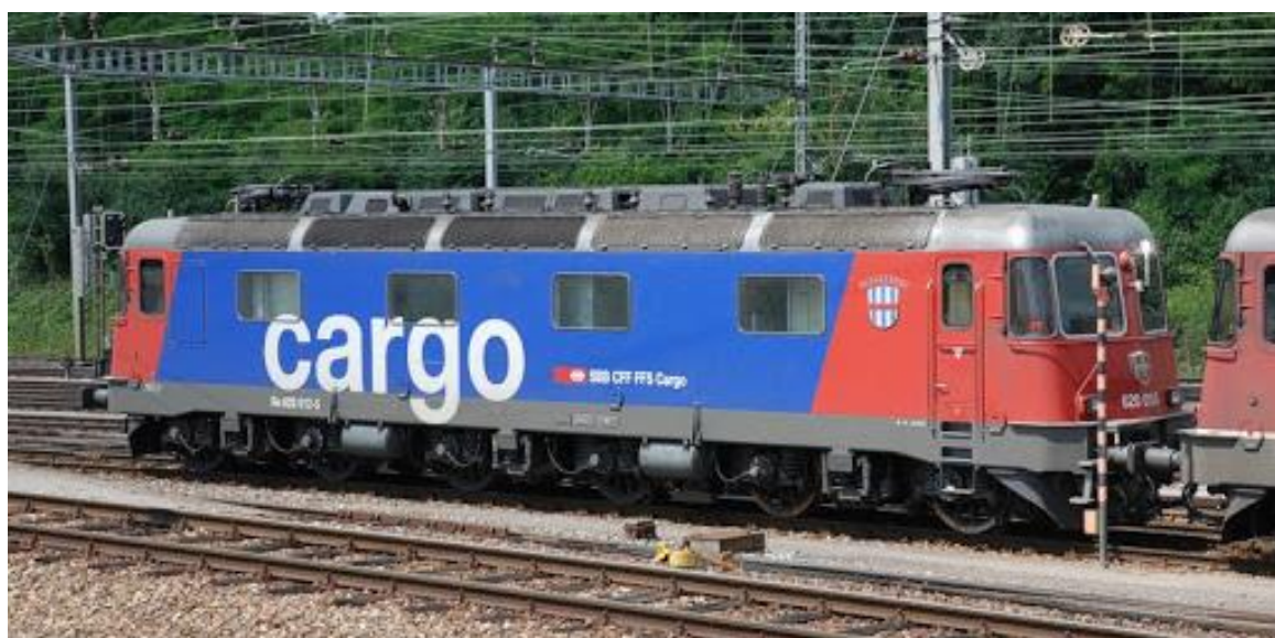
Abbildung 28: Die sechsachsigen Re620 werden vornehmlich für die schweren Nord-Südgüterzüge eingesetzt.
