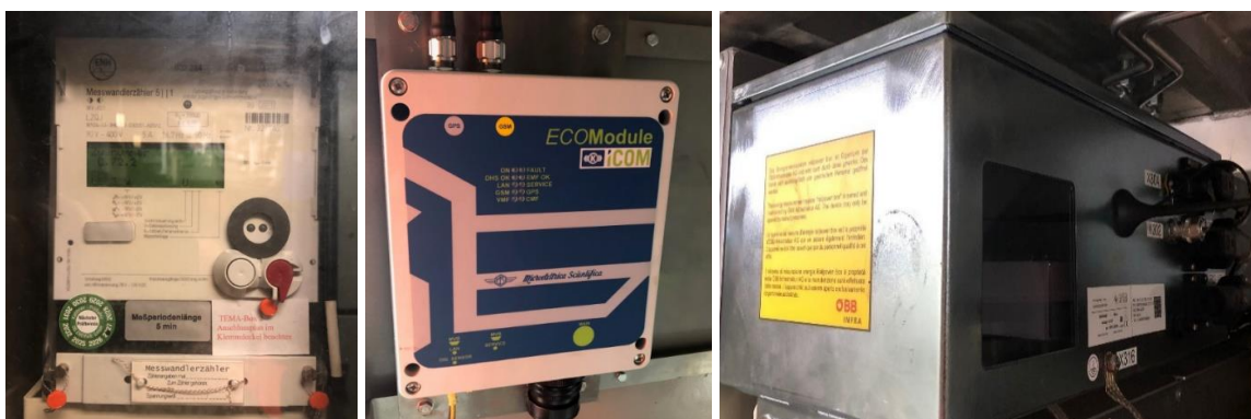
Abbildung 32: Verwendete Energiezähler auf den Lokomotiven von SBB Güterverkehr, links: DCS-System (DB Cargo, Mitte Eco Module SBB Infra, rechts Railpower-Box z.B. auf den Fahrzeugen der Baureihen Br 193
