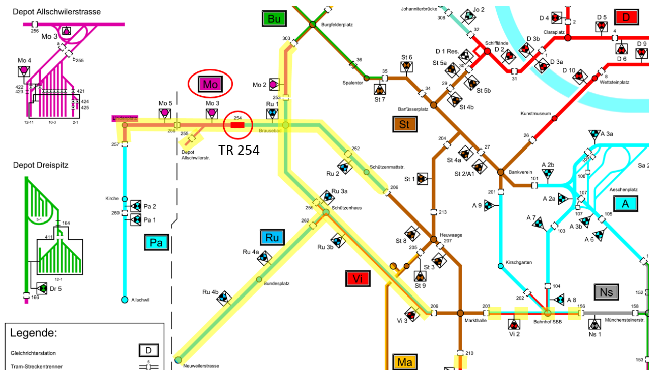
Abbildung 5-4: Speisegebiet 2 mit dem GR-Standort Morgarten als möglicher Standort für den Einsatz einer stationären Energiesparmassnahme (Wechselrichter oder Energiespeicher)
