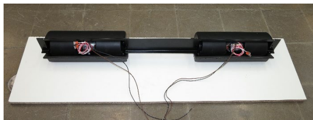
Abbildung 22 Ventilatoren vor dem Einbau in die Box
