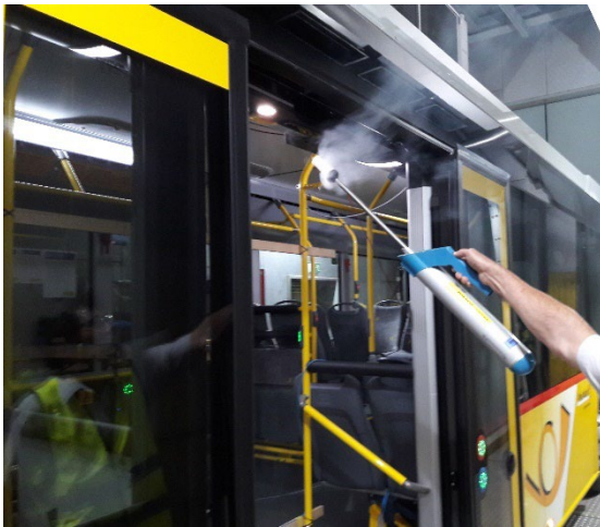
Abbildung 59 Strömungsvisualisierung mit Rauch an ET3, 15 °C Hallentemperatur; links TLS aus, rechts TLS ein
