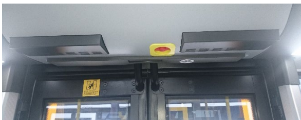
Abbildung 21 Türluftschleier im Postbus
