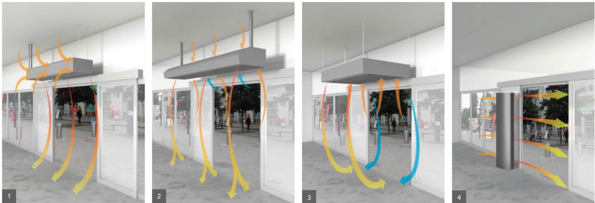
Abbildung 7 Übersicht der vier Haupt-Prinzipien von Türluftschleier Anlagen
