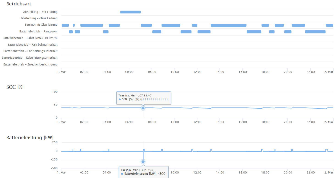
Abbildung 99: SoC und Ladeprofil für Eea 923 Rangierumlauf Oensingen, batterieschonende Ladung mit Abdecken einer 50-sekündigen Lastspitze im Bahnstromnetz durch Entladung um 07:13 Uhr.
