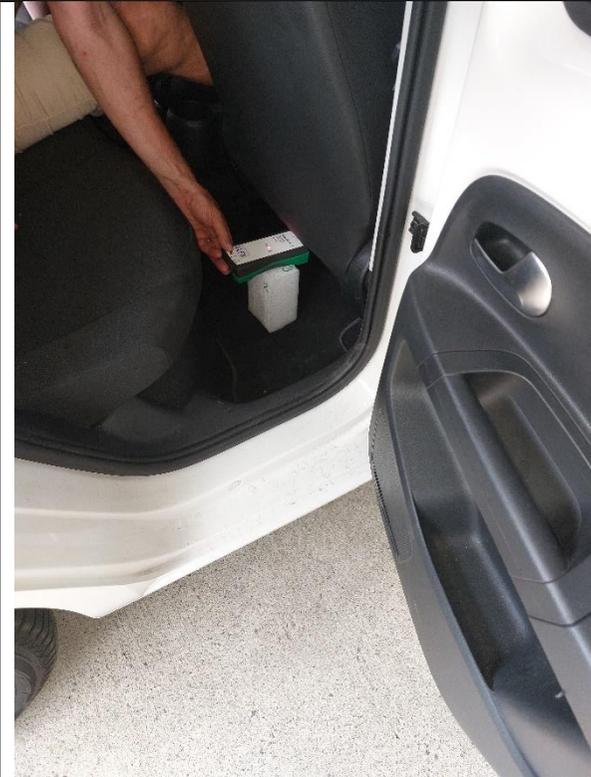
Abbildung 13: Messfahrt 1.1 - Schwenkmessung Fussboden hinten rechts (Niveau 3)
