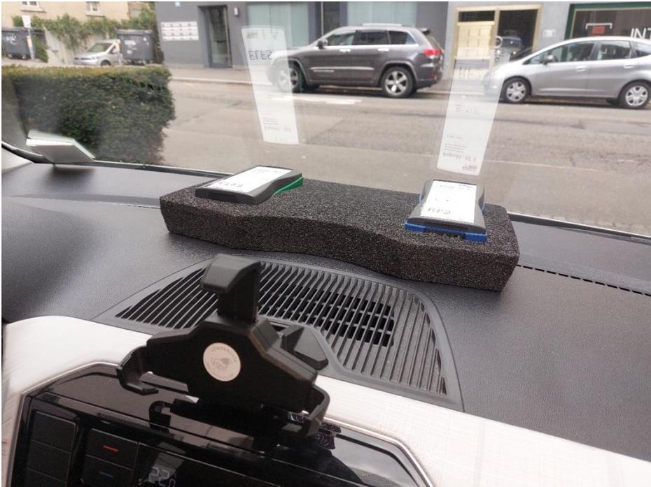
Abbildung 5: Platzierung von ELF5 und RF2 unter der Frontscheibe
