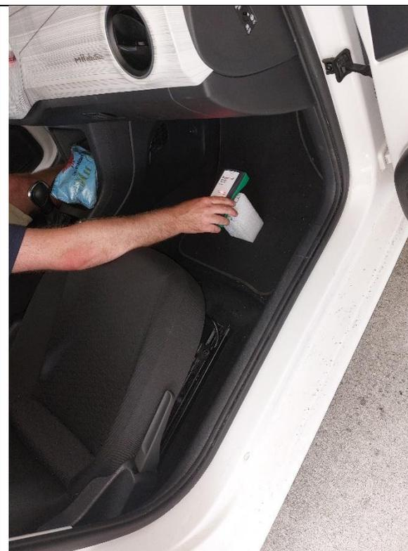
Abbildung 10: Messfahrt 1.1 - Schwenkmessung Fussboden vorne rechts (Niveau 3)
