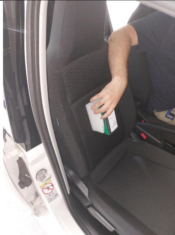
Abbildung 15: Messfahrt 1.1 - Schwenkmessung Rücklehne vorne rechts (Niveau 2)
