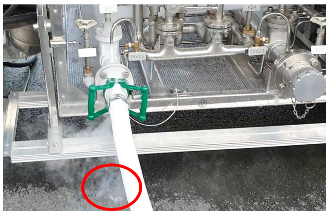
Abbildung 24: Leckage an der Kupplung bei der Wiederbefüllung der Tankstelle auf der Tankstellenseite
