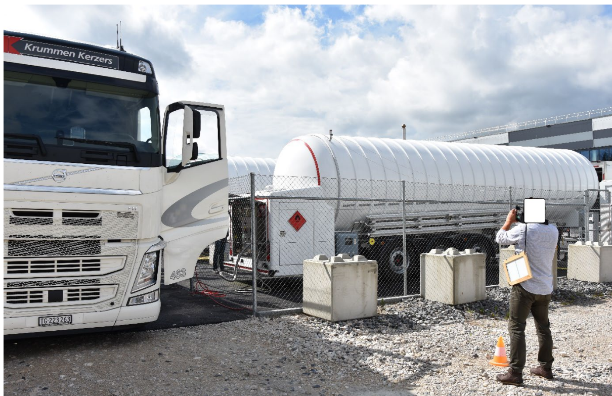
Abbildung 23: Messung von Methanemissionen mit einer Gas-Cam
