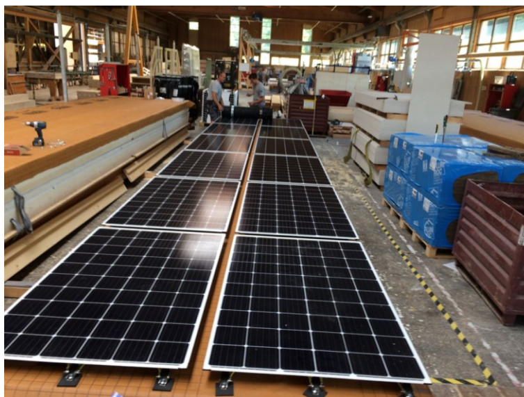
Fig. 7: élément préfabriqué (« superélément ») d'environ 20 m 2 composé par 12 éléments photovoltaïques, la couche d'étanchéité, le matériau d'isolation thermique, la barrière à la vapeur d'eau et comprenant une partie de la structure porteuse.
