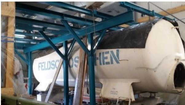
Das Podest für die Montage des Schredders und die Eintragsschnecken in den Vormischbehälter wird konstruiert.
