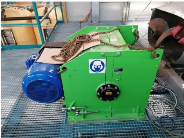
Der Schredder wird auf dem Podest der neuen Halle montiert.
