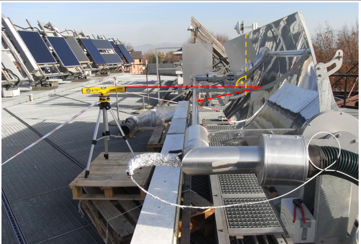
Abbildung 16: Messaufbau der Lasermessung zur Überprüfung der Reflektorgeometrie
