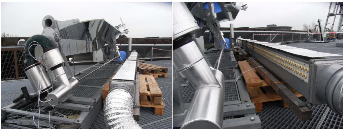
Abbildung 12: Windanlage mit Parabolrinnenkollektor in Park-Position für die Auskühlmessungen (die meistens während der Nacht durchgeführt wurden).
