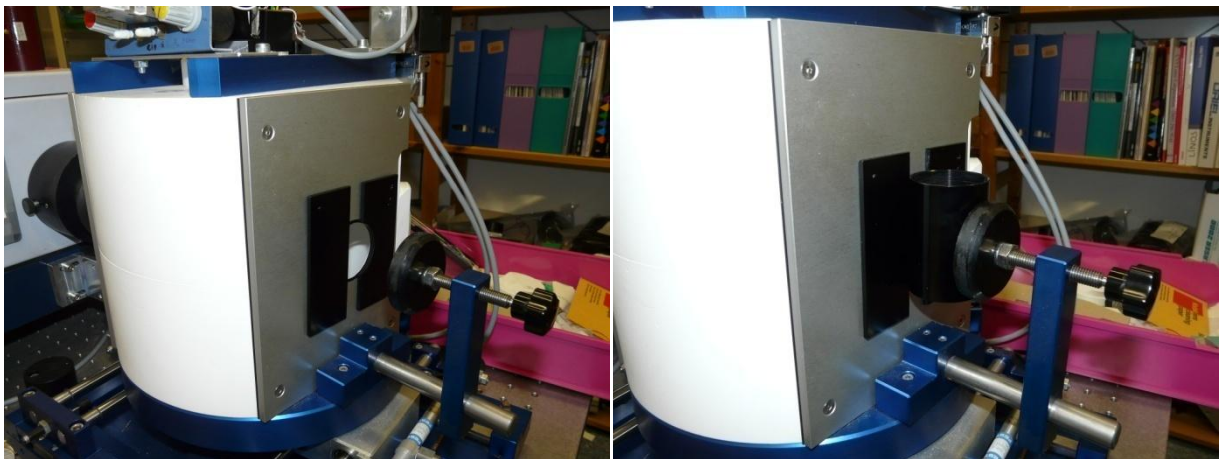
Abbildung 3: Ulbrichtkugel mit an Sample-Port montiertem Probenhalter für zylindrische Absorber (links), mit Absorberrohr in Messposition (rechts).
