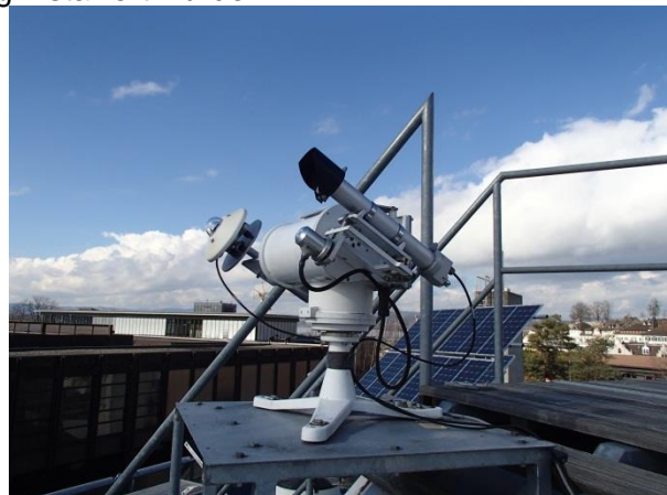
Abbildung 2.2-37: Pyrheliometer auf Meteotracker zur Direktstrahlungsmessung
