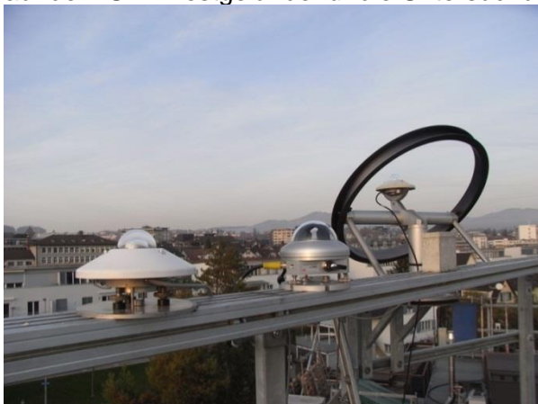
Abbildung 2.2-36: Pyranometer (links), SPN1 (Mitte) und Pyranometer mit Schattenring zur Diffusstrahlungsmessung (rechts)
