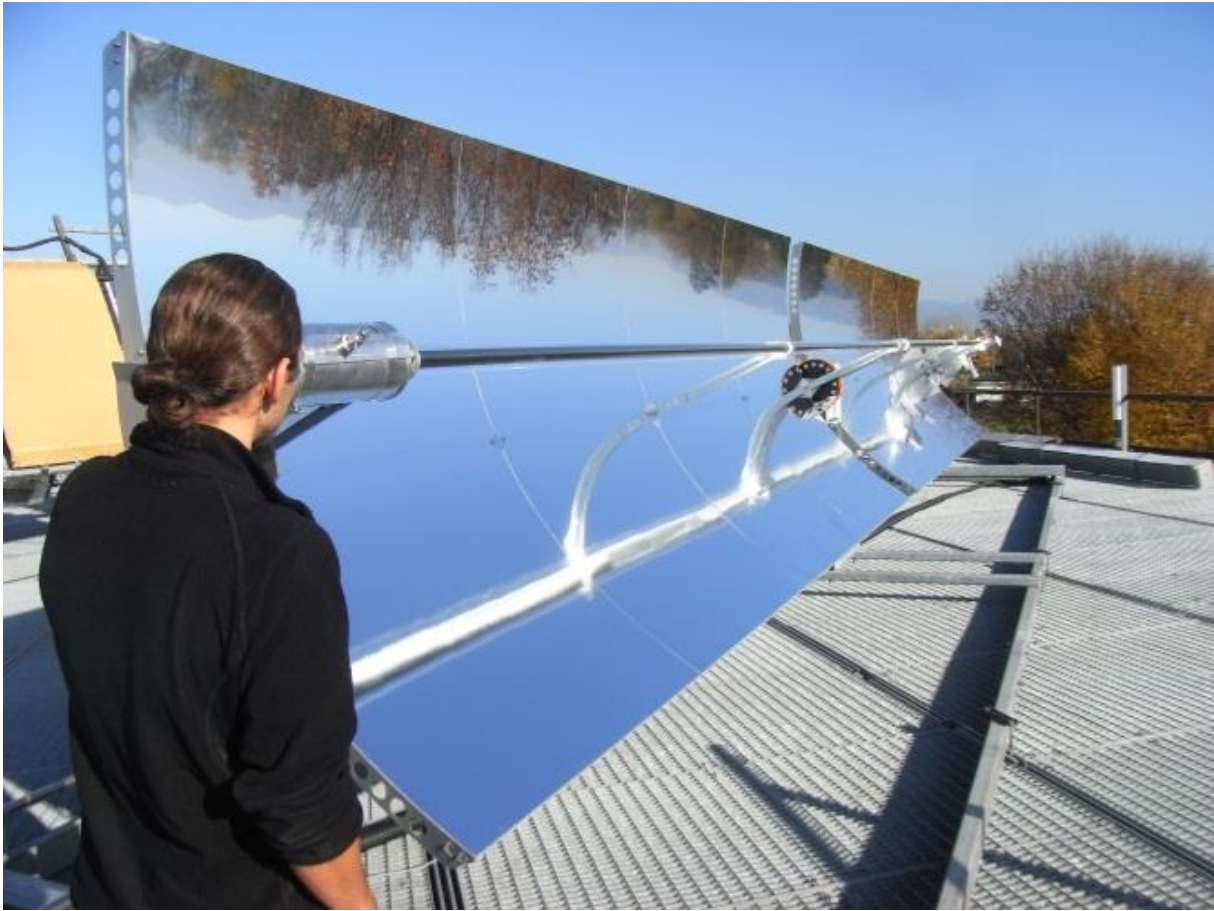
Abbildung 2.2-5: PT1800A auf dem SPF – Dach; Aperturweite 1.85 m. Kollektorlänge 11 m.
