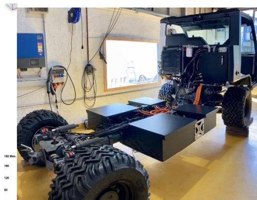
Alle Batteriehalterungen montiert am Fahrzeug
