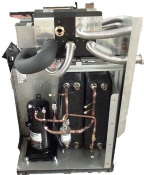
Abbildung 22: Innenansicht der eingesetzten Niedertemperaturhub-Wärmepumpe.
