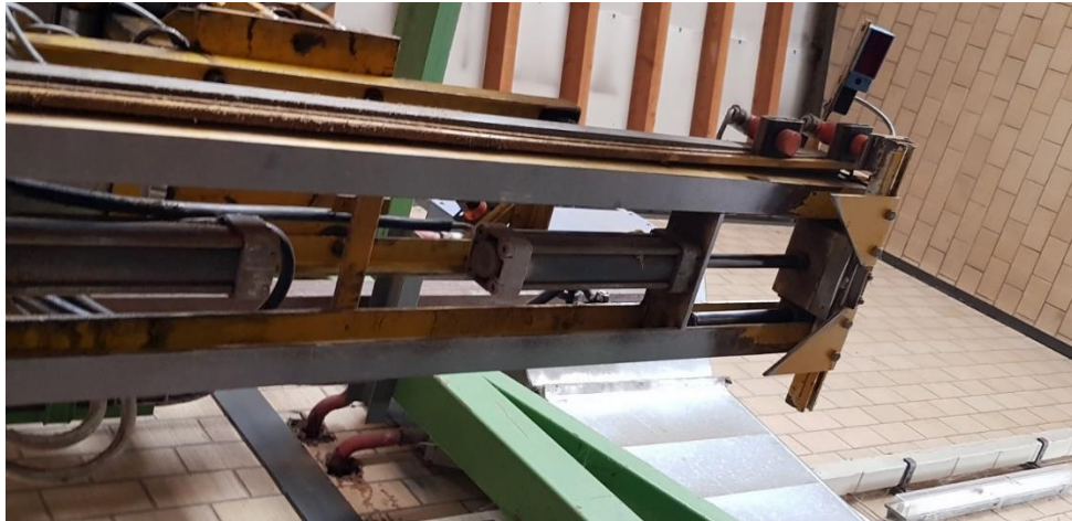
Abbildung 20: Zwei auszutauschende Pneumatikzylinder bei der Firma Kubrix AG
