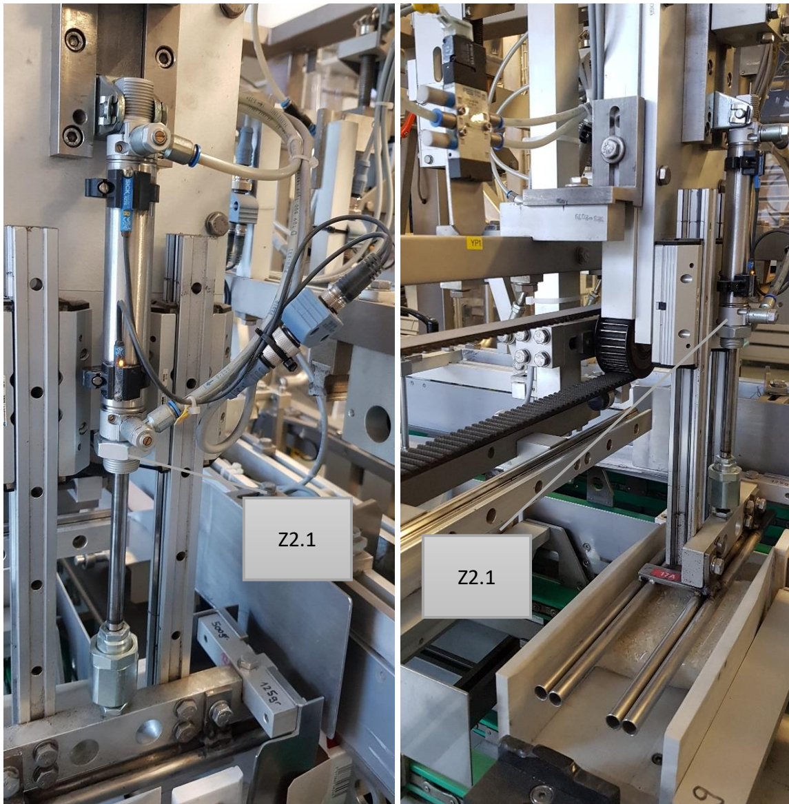
Abbildung 15: Projekt bei der Firma Reismühle Nutrex, zu ersetzender Zylinder Z2.1_Masek Andrücker Zylinder
