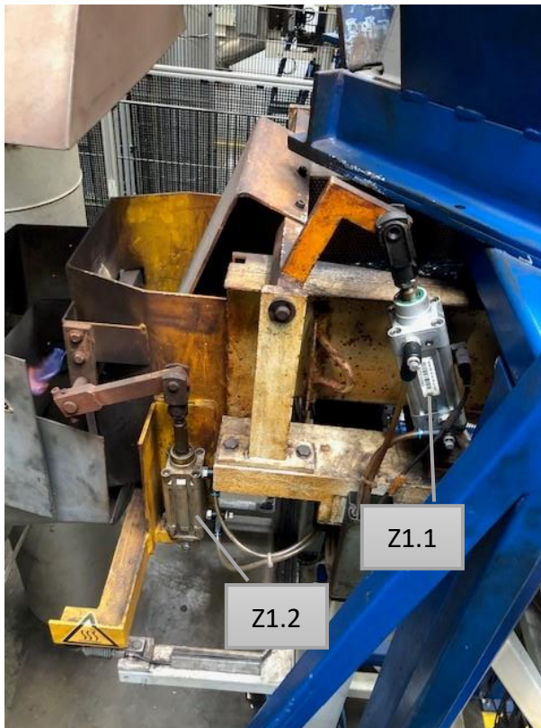
Abbildung 13: Pneumatikzylinder Z1.1 und Z1.2, welche durch CTC060 Zylinder ersetzt wurden
