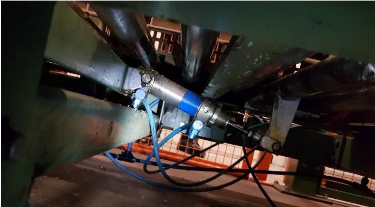
Abbildung 19: Beispiel eines zu ersetzenden Pneumatikzylinder s im «B-Gebinde Lager»
