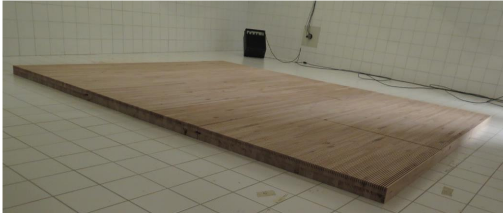
Abbildung 7: Prüfkörper der Deckenunterseite mit Profilierung im Hallraum. Quelle: Berner Fachhochschule.
