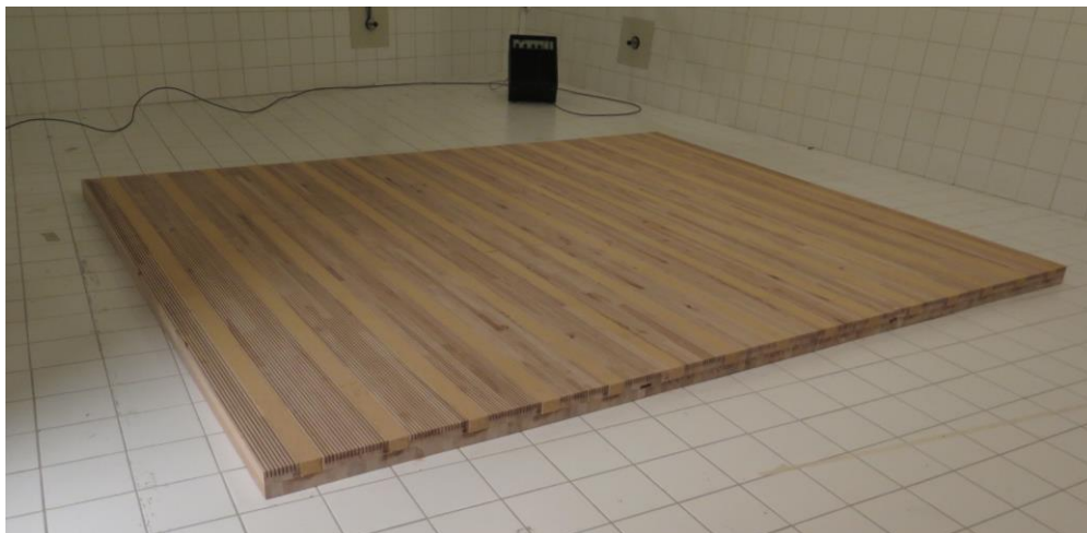
Abbildung 8: Prüfkörper der Deckenunterseite mit Profilierung und Aussparungen mit Pavatherm-COMBI im Hallraum. Quelle: Berner Fachhochschule.
