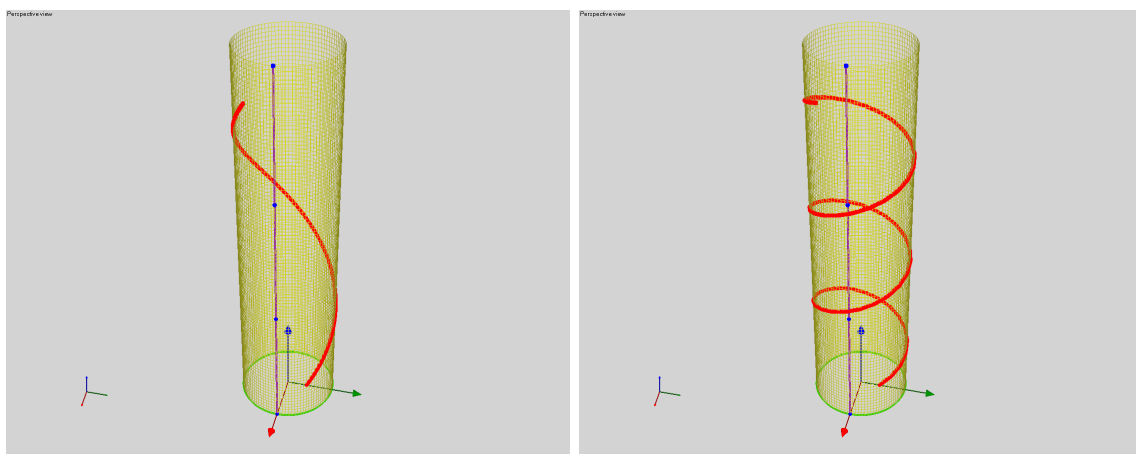
Figure illustrant le tracé d'une géodésique d'un ou plusieurs tours sur un cylindre
