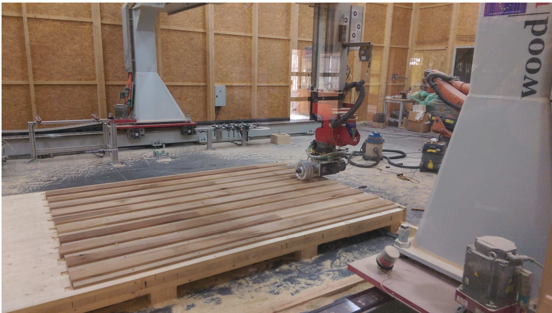
Usinage par un robot équipé d'une fraise multi-disques (La matrice est faite en un seul passage)
