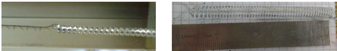
Abbildung 3: Künstlicher Muskel, einmal als Autocoil-Feder (links) und als heterochirale Feder (rechts) welche auf einen 4 mm Dorn aufgewickelt wurde. Im linken Bild befindet sich der Muskel gerade in der Fertigung und wird laufend aufgewickelt. Im noch nicht aufgewickelten Teil der Feder ist die Verdrillung der Faser anhand der schwarzen Linie zu sehen. Diese wurde als gerade Linie in Richtung der Faser auf die nicht verdrillte Faser aufgetragen.
