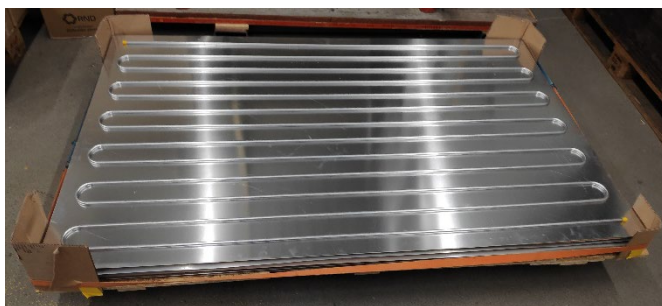
Abbildung 45: Aluminium-Absorberbleche mit aufgeschweisstem Mäander
