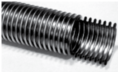
Abbildung 29: Wellschlauch: Die Wellen verlaufen senkrecht zur Schlauchachse und verhindern Torsionsspannungen
