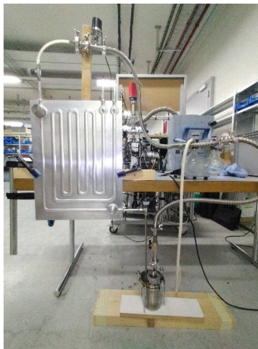
Abbildung 59: Aufbau für das Befüllen des Aktuatorkreises. In der rechten oberen Ecke des Bildes befindet sich der Rollbondabsorber mit dem Aktuator. Der Absorber ist oben über einen durchsichtigen Schlauch mit dem Drucksensor verbunden. Unten ist der Rollbondabsorber mit dem Wasser-Glykolegemisch Behälter verbunden. Auf der rechten Seite befindet sich (blau-grau) die Vakuumpumpe.
