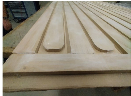
Abbildung 49: Holzplatte mit Ausschnitten für den Mäander. Diese ist ebenfalls mit Wachs überzogen.
