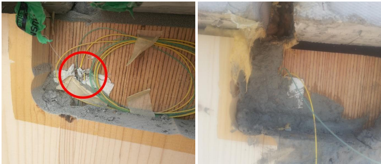
Abbildung 34: Beschädigte Sensoren an der Stütze Wand im EG (links) und eingedrungener Zement in der Stütze Wand im 6. OG (rechts) (Quelle: Marmota Engineering)
