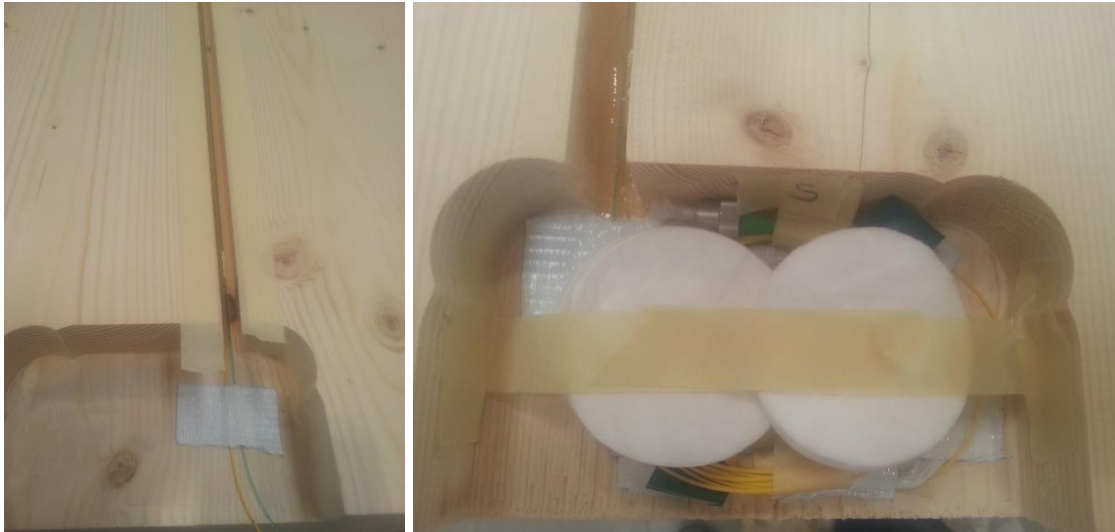
Abbildung 31: Einkleben der faseroptischen Sensorkabel (links) und Schutz der Sensorkabel für den Transport (rechts) (Quelle: Marmota Engineering)
