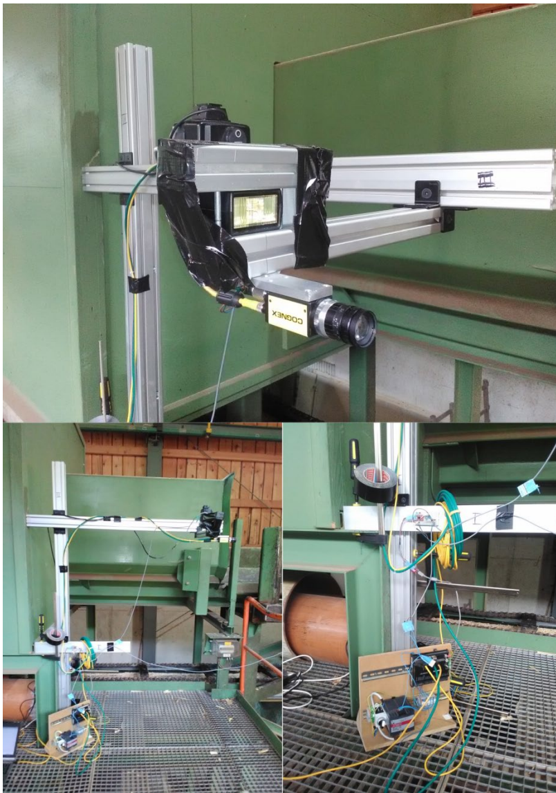
Abbildung 7: Setup Probeaufnahmen Sägewerk. Oben: Detail Kamera und blitz. Links unten: Gesamtaufbau fixiert am Gehäuse des Laserscanners. Rechts unten: Detail Kontrollbox.
