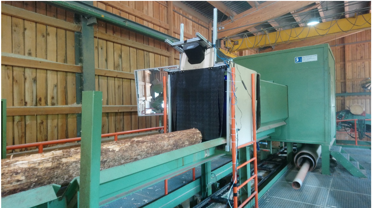
Abbildung 20: An Laserscanner angeschlossener Testaufbau für Aufnahmen von Stammquerschnitten unter UV Beleuchtung.
