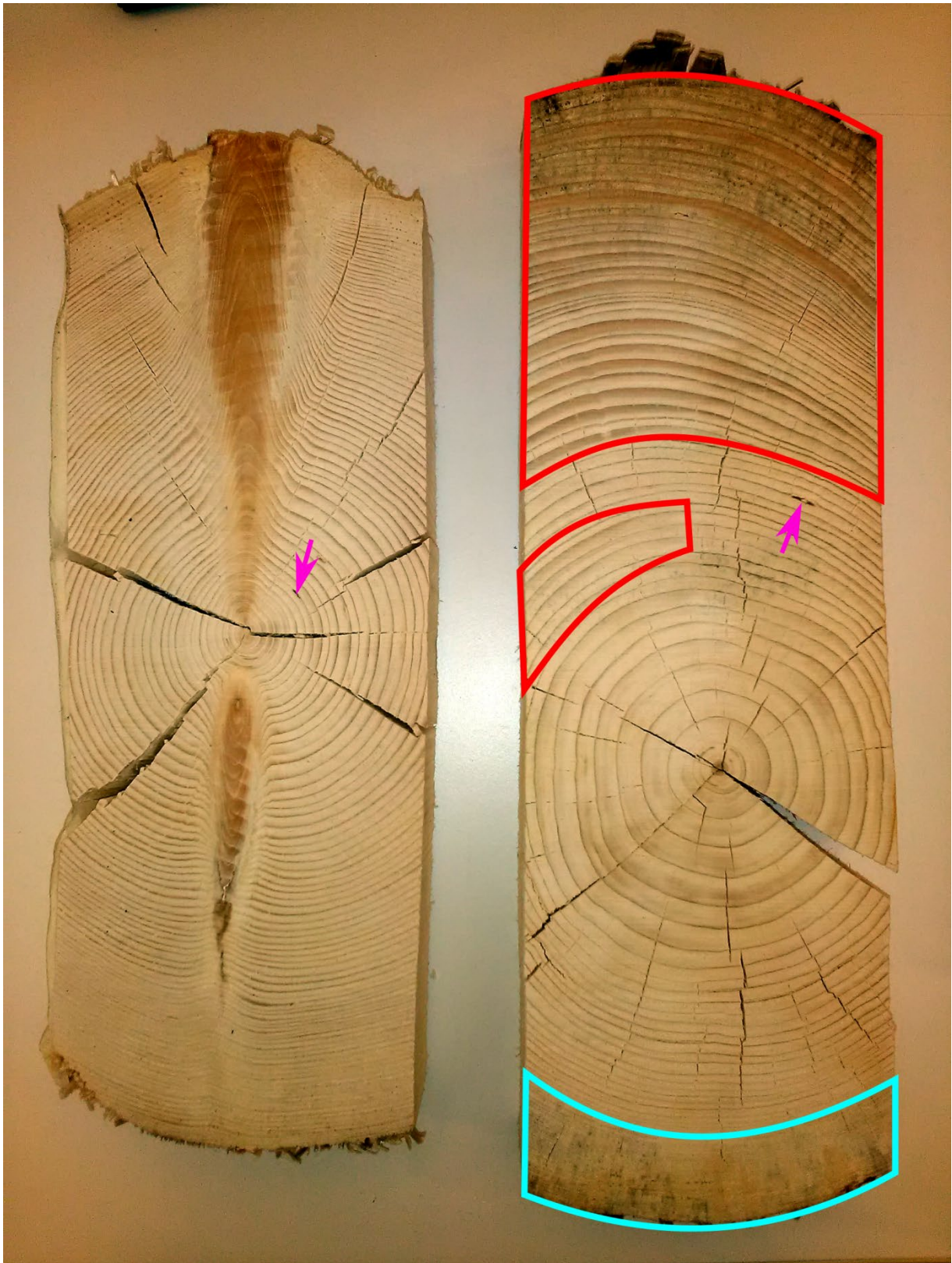
Abbildung 11: Probekörper für hyperspektrale Aufnahmen. Magenta Pfeile zeigen auf Harzgallen. Links: Querschnitt normales Holz, in der Mitte sind zwei vertikal verlaufende angeschnittene Äste erkennbar. Rechts: Querschnitt mit Druckholz (rote Einrahmung), zusätzlich ist im Cyan eingerahmten Bereich Blaufäule sichtbar.
