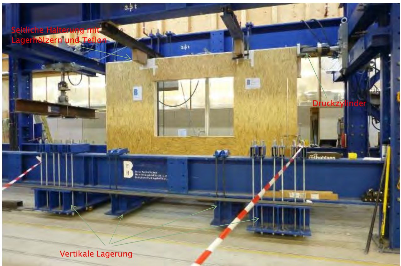
Abbildung 5: Wand mit Öffnungen auf dem Prüfraum der BFH-AHB, Biel Versuchsaufbau für monotone Prüfung
