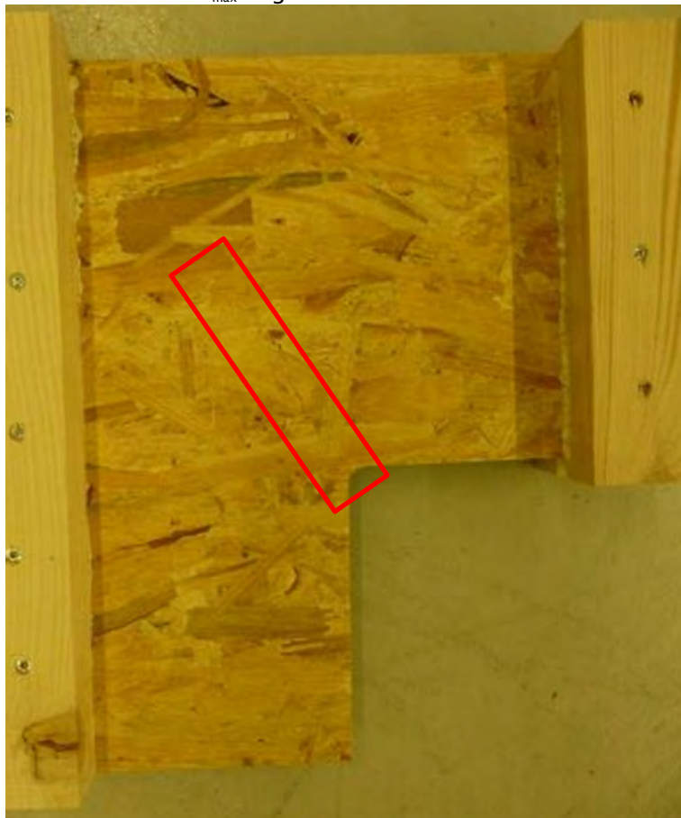
(a) Rissfortsatz innerhalb der roten Box des Prüfkörpers EG_R8_I_05
