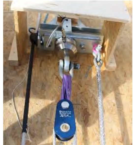
(b) Auslösemechanismus mit Kraftmessdose und Anhängpunkt
