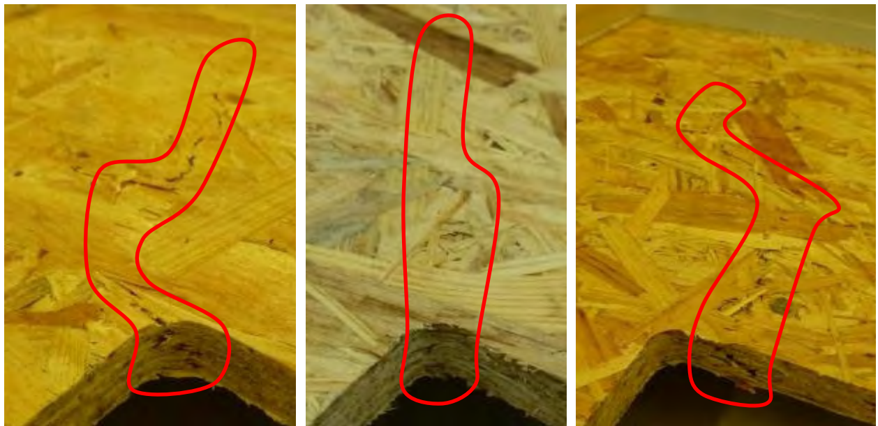
(a) Bruch läuft zuerst horizontal weg und anschliessend in Richtung der Krafteinleitung
