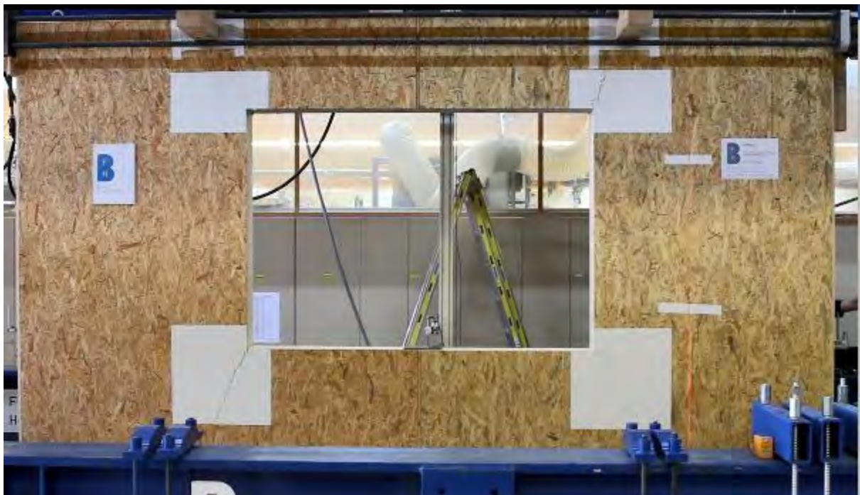
Abbildung 8: Wand (PK 3.2) mit C-förmigen, gerissenen Beplankungsplatten
