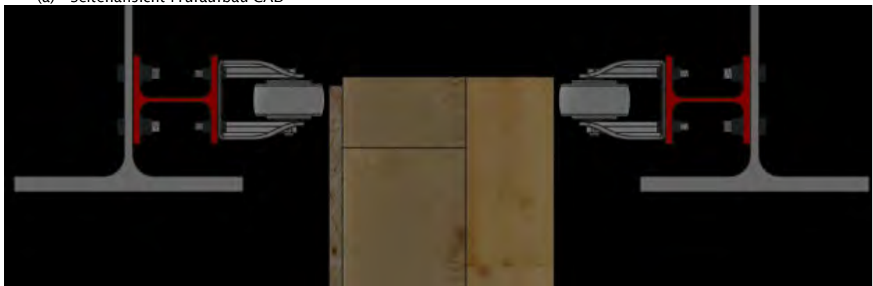
(b) Kipphalterung aus der Ebene CAD
