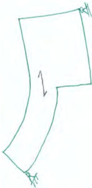
(c) Verformung des Eckgeometrie Prüfkörpers aufgrund der Belastung
