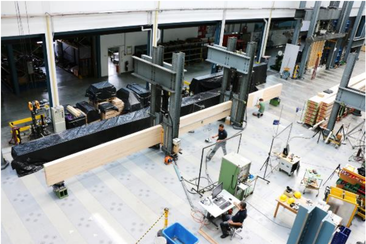
Abbildung 17: Setup zur 4-Punkt Biegeprüfung eines Buchen-BSH Trägers mit einer Höhe von 800 mm und einer Spannweite von 14.4 m; 15. August 2017.
