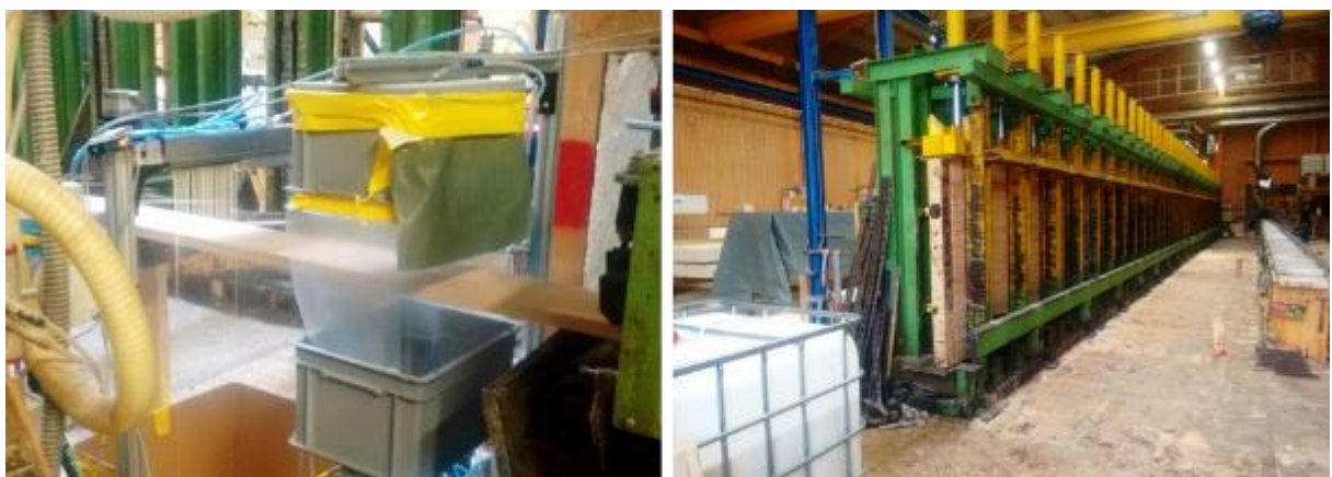
Abbildung 11: Auftrag von Primer und Klebstoff (links) sowie Pressvorgang (rechts) bei der Firma neue Holzbau AG in Lungern; 8. Mai 2017.
