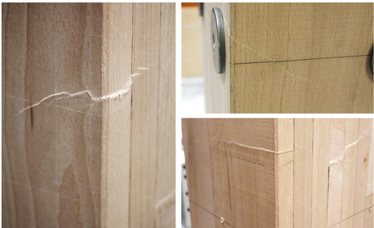
Abbildung 39: Druckfalten im Bereich der Biegedruckbeanspruchung von Prüfkörpern mit einer Knicklänge von 2400 mm.
