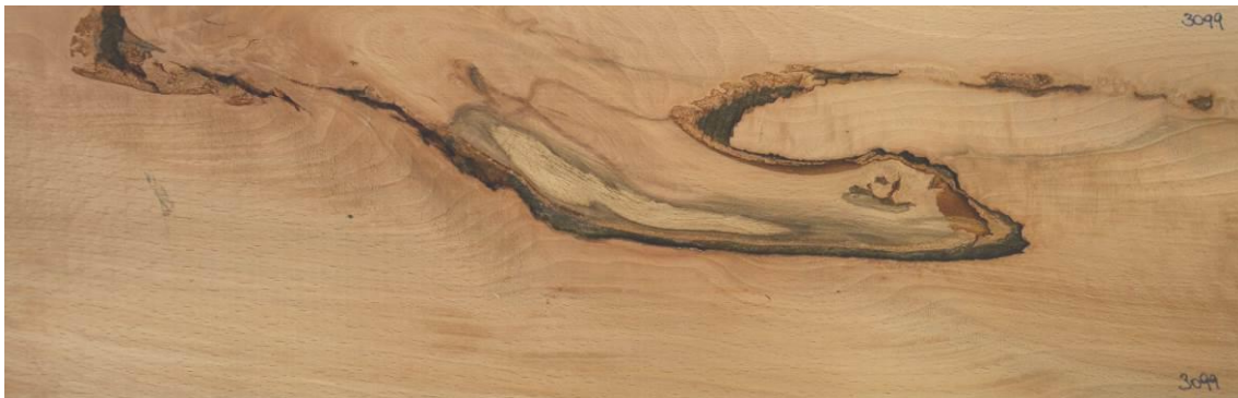
Abbildung 10: Aufgrund der Astgrösse offensichtlich zu deklassierende Lamelle.
