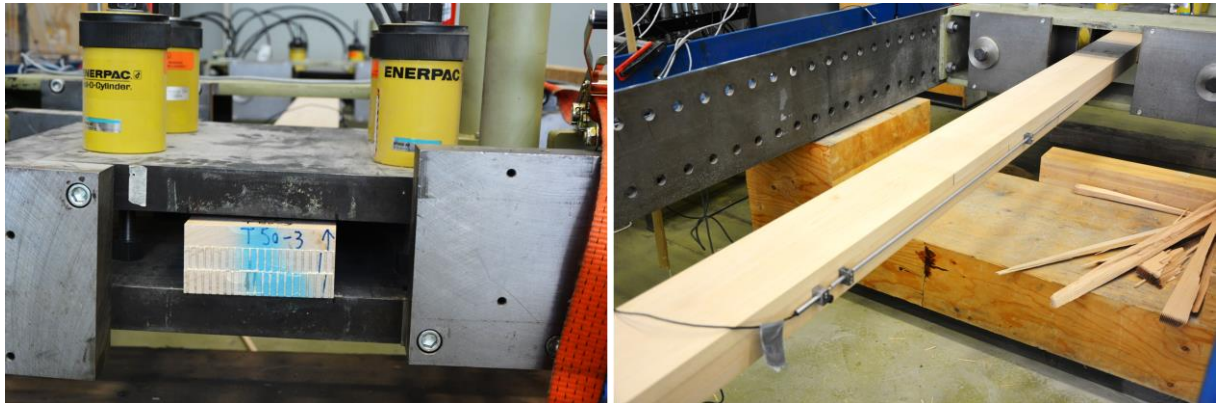
Abbildung 50: Einspannbereich der 3-schichtigen Lamellenbündel (Festigkeitsklasse T50, links) und Messeinrichtung mit LVDTs zur Bestimmung des statischen Zug-Elastizitätsmoduls parallel zur Faserrichtung (rechts).
