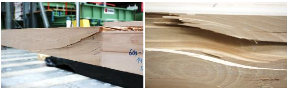
Abbildung 28: Schubversagen in der Randlamelle entlang der Holzfasern aufgrund erhöhter genereller (links) und lokaler Schrägfasrigkeit (rechts).
