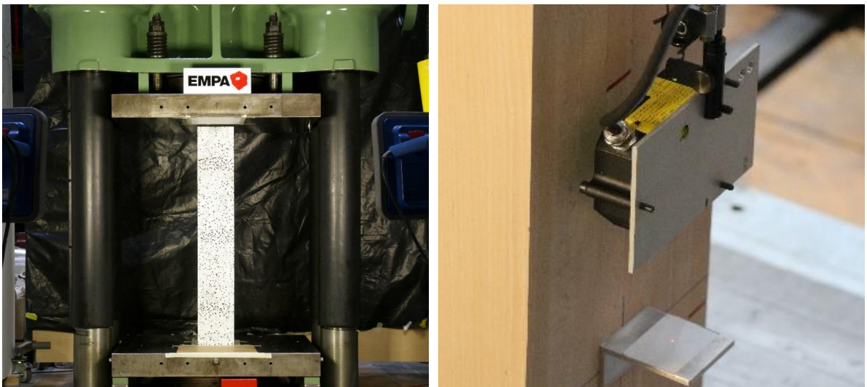
Abbildung 30: Prüfaufbau zur Bestimmung der Druckfestigkeit und des Druckelastizitätsmoduls (links) sowie beidseitig montierte Laser zur optischen Messung der Verformungen über eine Länge entsprechend der 4-fachen Querschnittsabmessung (rechts).
