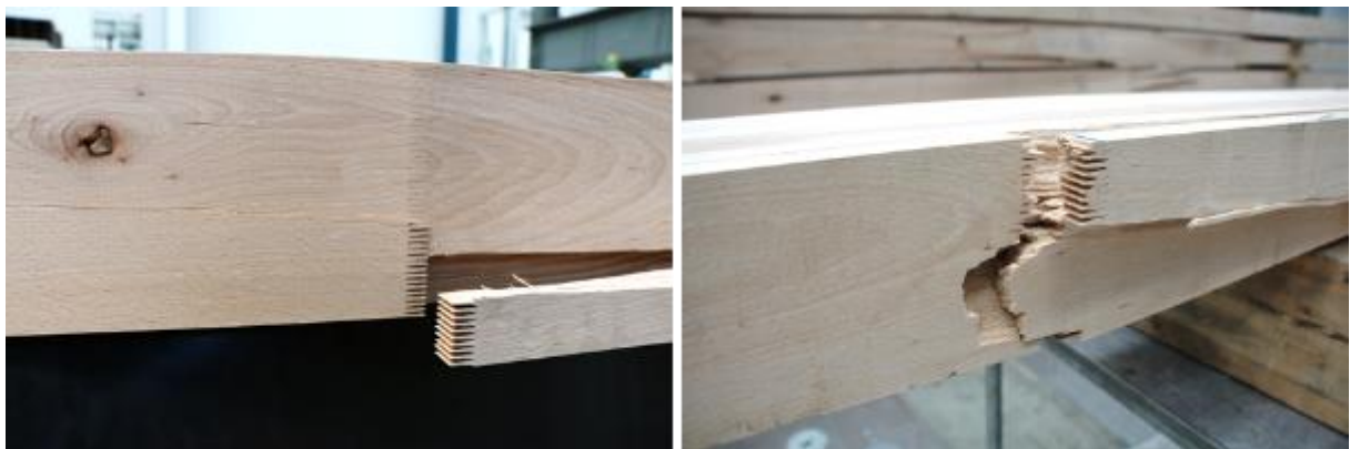
Abbildung 27: Keilzinkenversagen in der Randlamelle kombiniert mit einem Schubbruch entlang der Faser (links) und kombiniert mit Holzbruch über rd. 2/3 des Querschnittes (rechts).
