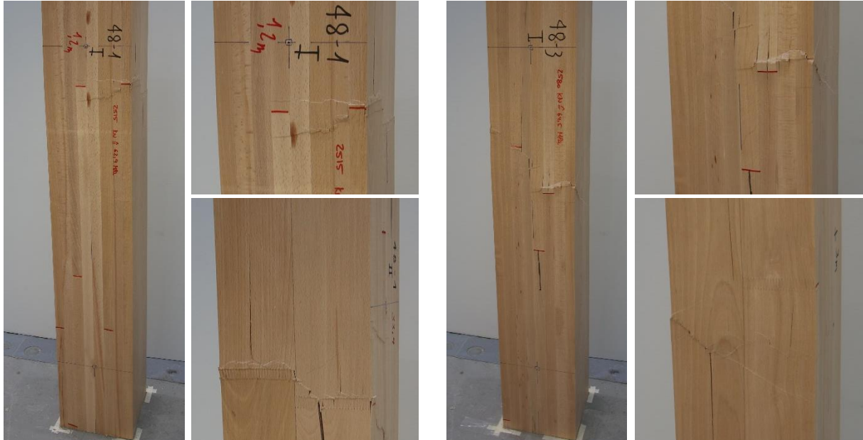
Abbildung 37: Prüfkörper der Festigkeitsklasse GL48h und Querschnittsabmessung a = 200 \text{ mm} nach erfolgter Druckprüfung. Grosse Deformationen (Druckfalten) treten vor allem im Bereich von Keilzinkenverbindungen und Faserabweichungen auf und sorgen für ein duktilen Verhalten der Prüfkörper.
