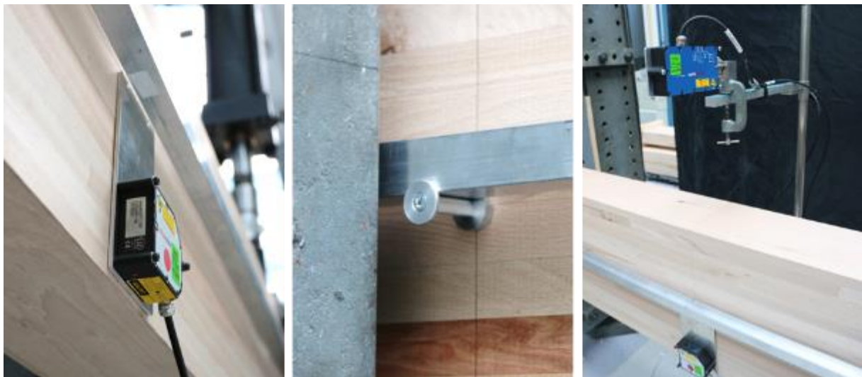
Abbildung 19: Beidseitig montierte Laser zur optischen Messung der lokalen (Biege-) Verformung (links), Halterung und Führung der Messlatte zur Ermittlung des lokalen Biege-Elastizitätsmoduls (Mitte) und laseroptische Messung der globalen Vertikalverformung (rechts).
