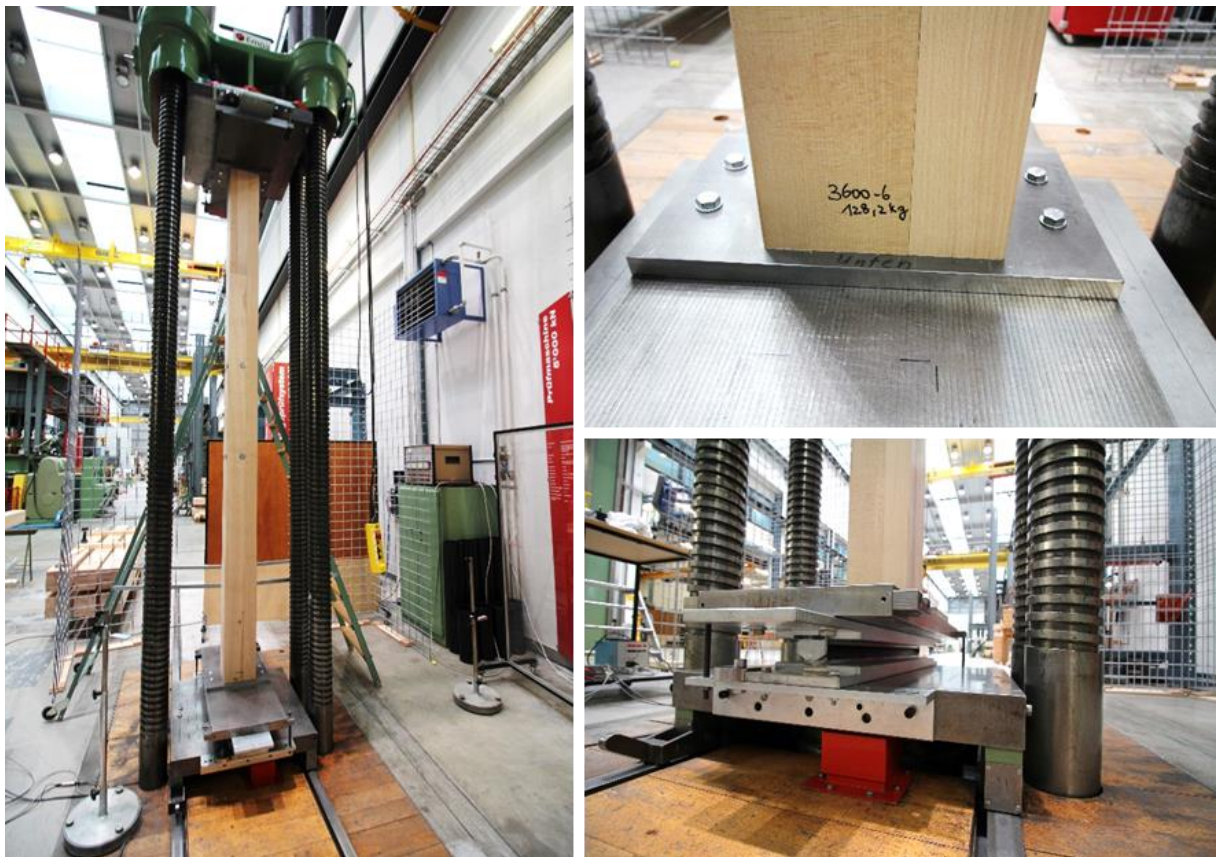
Abbildung 33: Prüfaufbau zur Bestimmung der Knicklast einer Stütze mit Knicklänge 3600 mm (links) sowie Grundplatte zur Montage und gelenkigen Lagerung (rechts, oben und unten).
