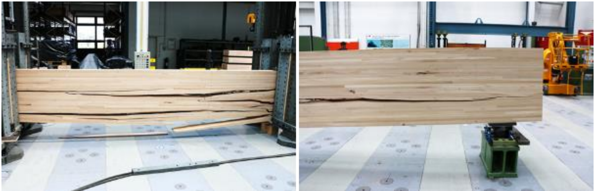
Abbildung 29: Schubbrüche über 2/3 der Höhe (links) und bis zum Auflagerbereich (rechts) als sekundärer Bruchmechanismus nach dem Versagen der Zugrandlamelle.
