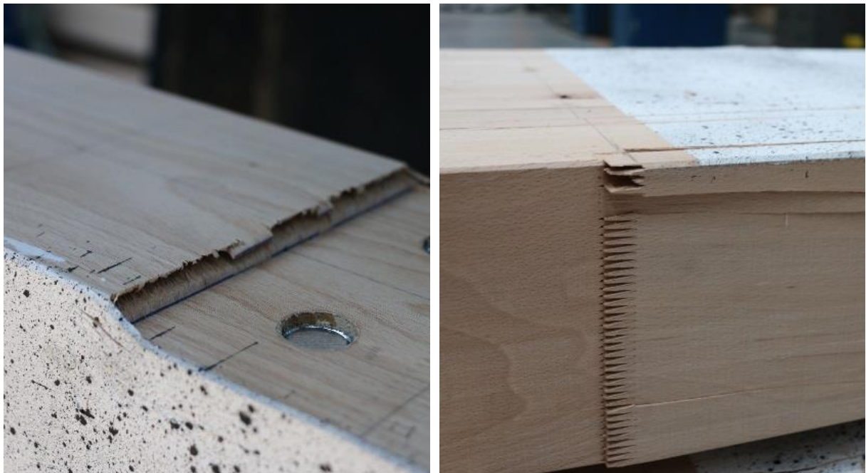
Abbildung 41: Ungewünschte starke Eindrückungen rechtwinklig zur Faserrichtung im Bereich der Lasteinleitung trotz eingeklebter Gewindestangen (links) und unerwünschtes Biegezugversagen im Bereich einer Keilzinkenverbindung (rechts).
