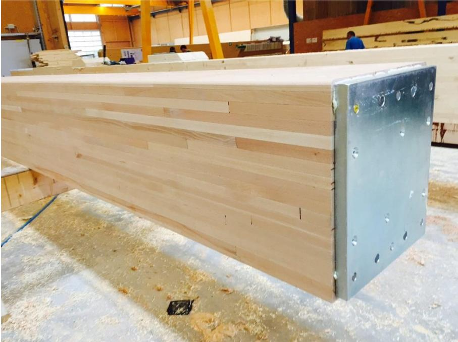
Abb. 13: Grundplatte fürs aufschweißen auf der Baustelle
