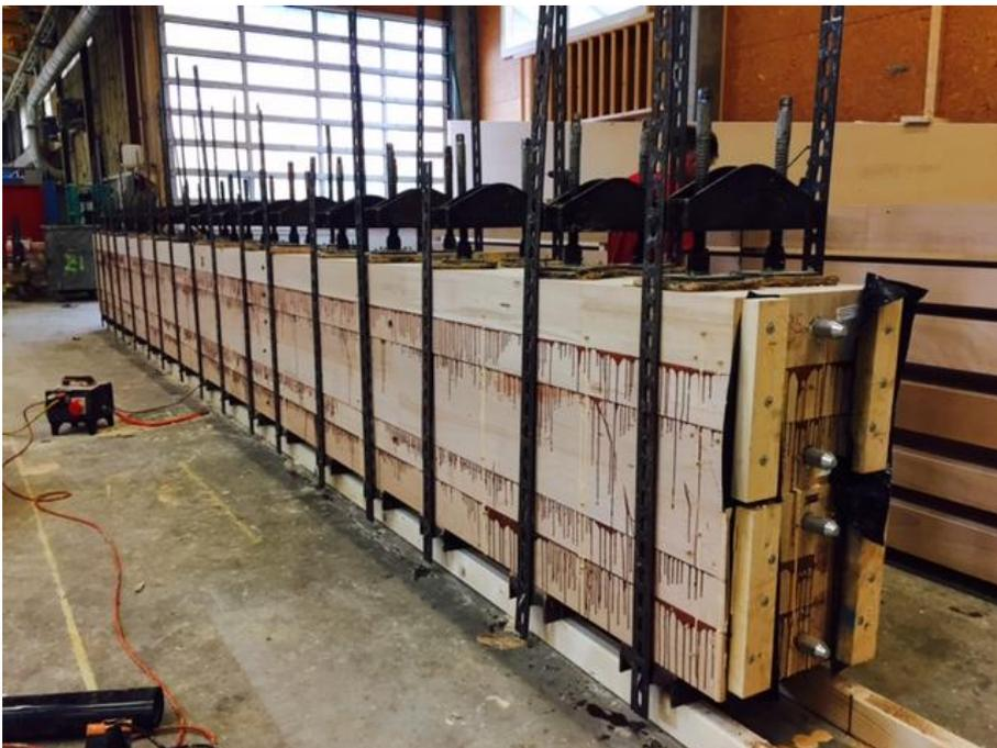
Abb. 2: Blockverleimungen der Bu-Stutzen
