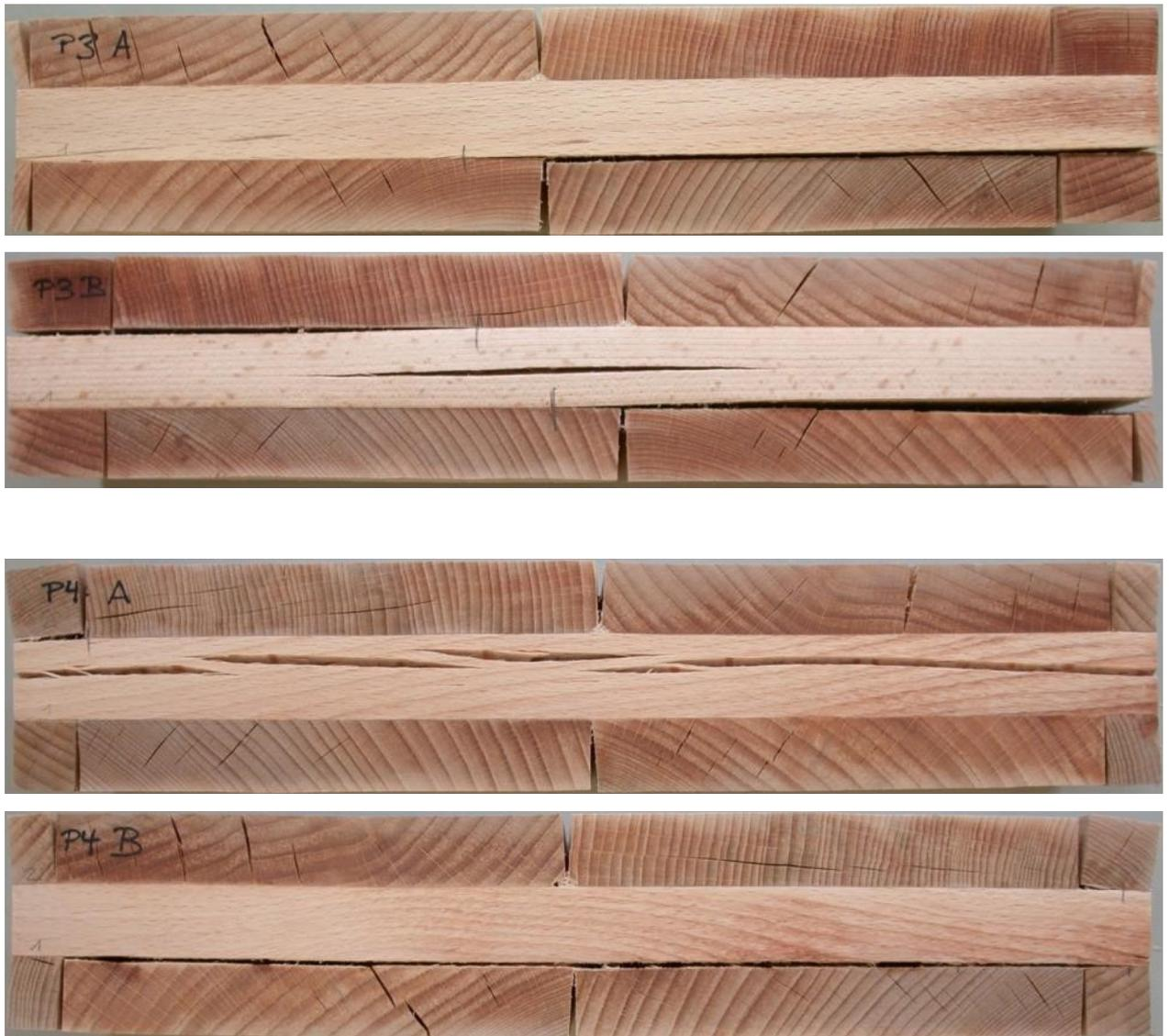
*Abbildung 2: Lange Seiten der Querschnittsflächen aller Delaminierungsproben (P1, P2, P3 und P4) nach der Trocknung*
