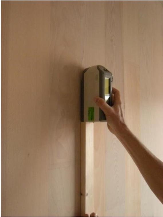
Abbildung 43: Farbmessung auf der Sichtfläche der Buchen-Brettsper Holzplatten
