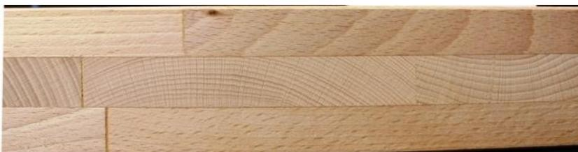
Abbildung 9: Plattenaufbau Buchen-Sperrholzplatte
