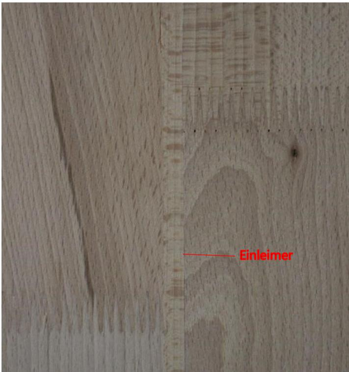
**Abbildung 11: Plattenoberfläche mit Keilzinkung und Einleimer zwischen zwei 1 m breiten Teilplatten**
