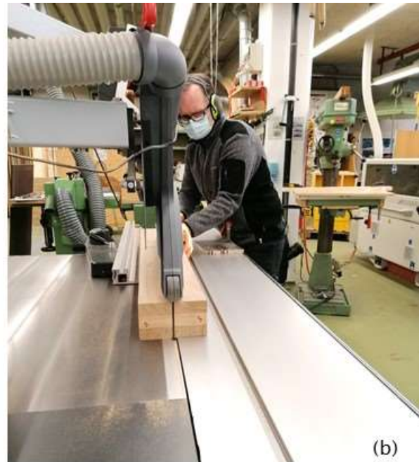
Abb. 9: Angelieferte BSH-Rohlinge mit den Abmessungen 1100 \times 160 \times 90 \text{ mm}^3 (a). Jeder Rohling wurde sowohl in der Länge als auch in der Breite geteilt, um Prüfkörper mit den Abmessungen 468 \times 78 \times 90 \text{ mm}^3 zu erhalten (b).
