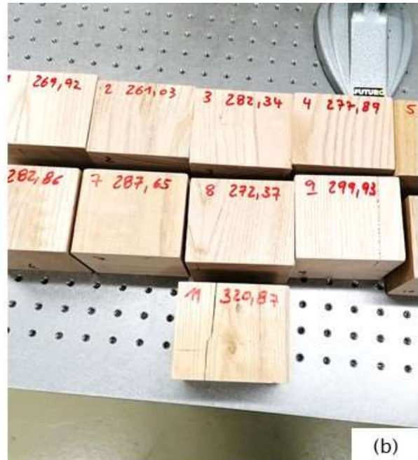
Abb. 10: Zugeschnittene, beschriftete und nach den zugeordneten Klimabereichen gruppierte BSH Prüfkörper (hier Kastanie) mit den Abmessungen 468 \times 78 \times 90 \text{ mm}^3 (a). Die beim Zuschnitt anfallenden Restabschnitte (b) wurden zur Bestimmung der Holzfeuchte bei der Anlieferung mit dem Darrverfahren nach EN 13183-1 [25] verwendet.
