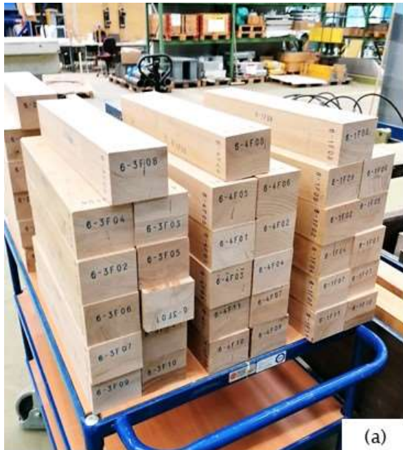
Abb. 10: Zugeschnittene, beschriftete und nach den zugeordneten Klimabereichen gruppierte BSH Prüfkörper (hier Kastanie) mit den Abmessungen 468 \times 78 \times 90 \text{ mm}^3 (a). Die beim Zuschnitt anfallenden Restabschnitte (b) wurden zur Bestimmung der Holzfeuchte bei der Anlieferung mit dem Darrverfahren nach EN 13183-1 [25] verwendet.
