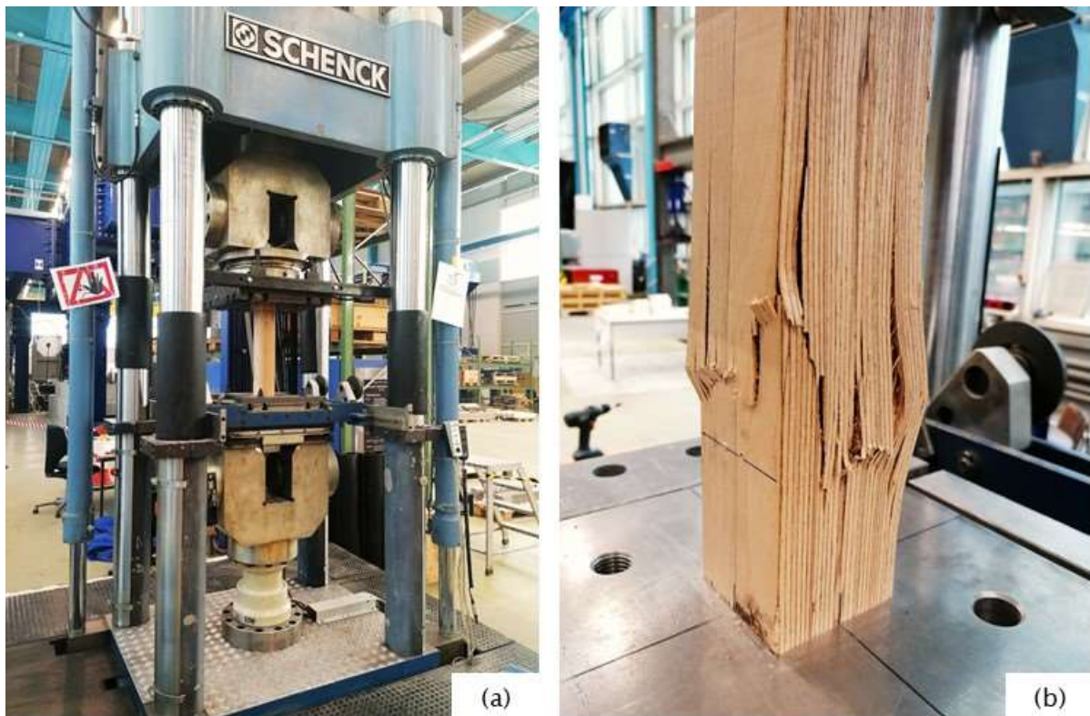
Abb. 12: Zur Bestimmung der Druckfestigkeit und des Elastizitätsmoduls parallel zur Faserrichtung genutzte Prüfmaschine «Schenck 1600». Die Prüfungen wurden weggesteuert mit einer konstanten Vorschubgeschwindigkeit von 0.02 mm/s durchgeführt.
