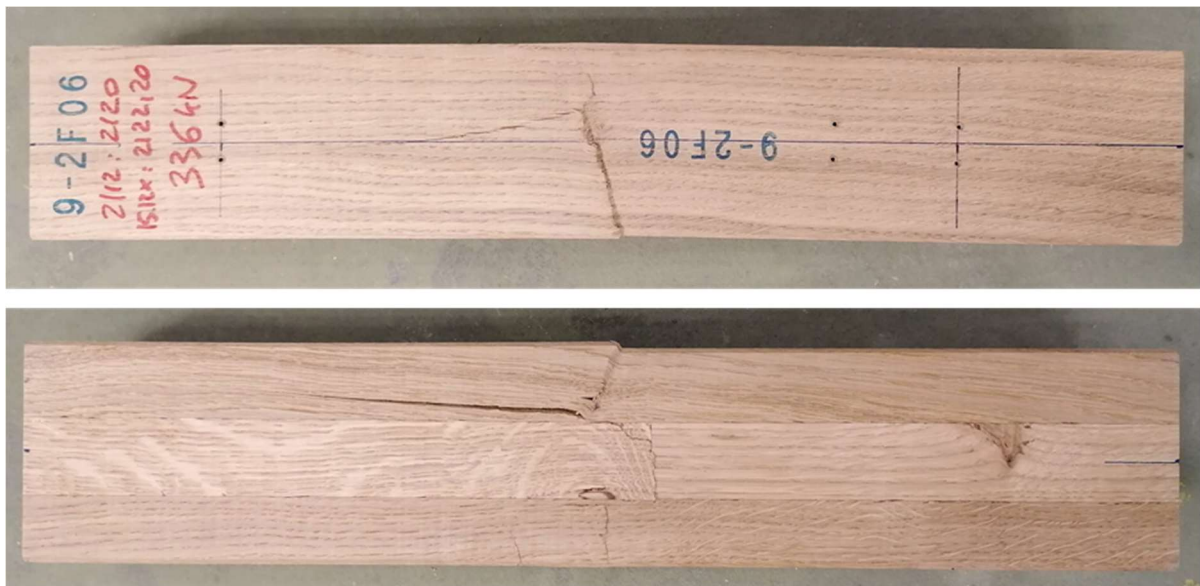
Abb. 19: Typisches Versagensbild eines Prüfkörpers aus Eichen BSH (Feuchtebereich «2F»). Ausgeprägte Faserstauungen über den gesamten Querschnitt, oftmals im Bereich von Ästen oder Keilzinkenverbindungen, führten zu einem sehr duktilen Versagen ( f_{c,0} = 47.6 \text{ MPa} ).
