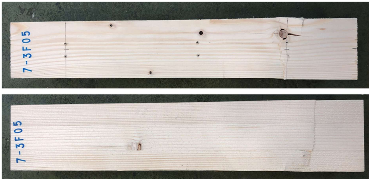
Abb. 25: Typisches Versagensbild eines Prüfkörpers aus Fichten BSH (Feuchtebereich «3F»). Ausgeprägte Faserstauungen, oftmals im Bereich von Keilzinkenverbindungen und Ästen oder Astgruppen, führten zu einem duktilen Versagen ( f_{c,0} = 42.5 \text{ MPa} ).
