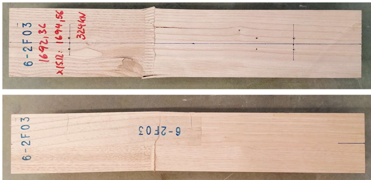
Abb. 23: Typisches Versagensbild eines Prüfkörpers aus Kastanien BSH (Feuchtebereich «2F»). Ausgeprägte Faserstauchungen, oftmals im Bereich von Keilzinkenverbindungen oder Astbereichen, führten zu einem duktilen Versagen ( f_{c,0} = 45.5 \text{ MPa} ).
