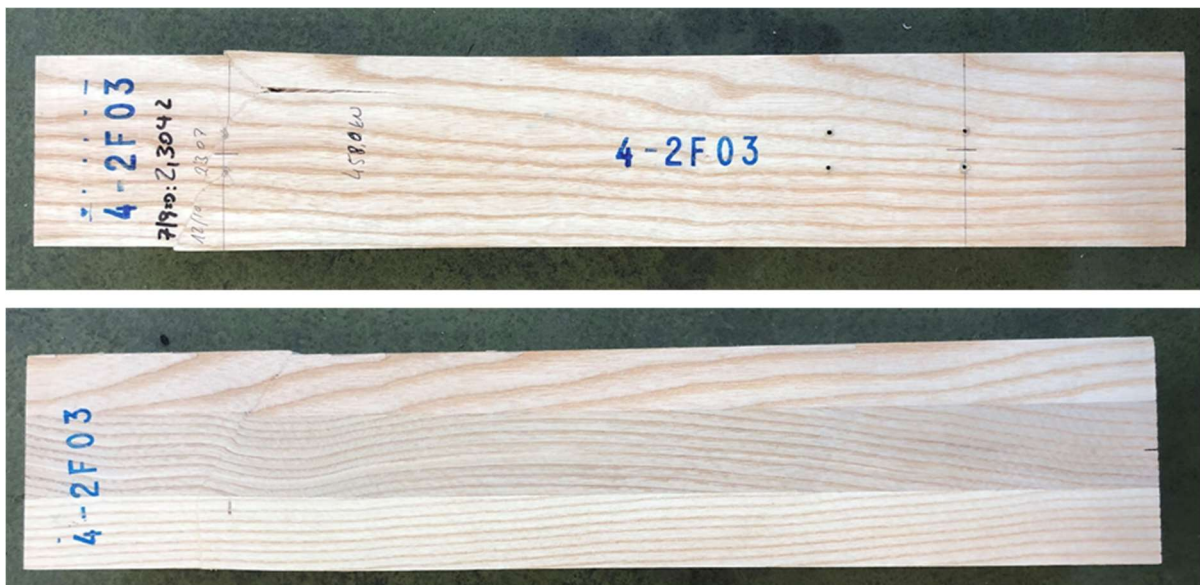
Abb. 21: Typisches Versagensbild eines Prüfkörpers aus Eschen BSH der Festigkeitsklasse GL 48h (Feuchtebereich «2F»). Ausgeprägte Faserstauchungen, oftmals im Bereich von Keilzinkenverbindungen oder Astbereichen, führten zu einem sehr duktilen Versagen ( f_{c,0} = 65.2 \text{ MPa} ).
