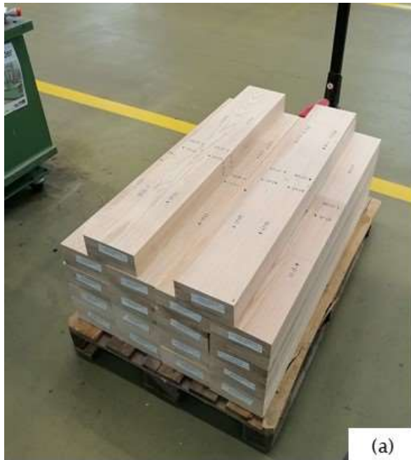
Abb. 9: Angelieferte BSH-Rohlinge mit den Abmessungen 1100 \times 160 \times 90 \text{ mm}^3 (a). Jeder Rohling wurde sowohl in der Länge als auch in der Breite geteilt, um Prüfkörper mit den Abmessungen 468 \times 78 \times 90 \text{ mm}^3 zu erhalten (b).
