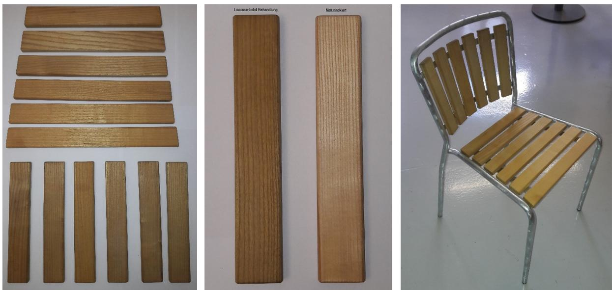
**Abbildung 5:** a) Behandelte Sitz- und Rückenlatten aus Eschenholz. b) Vergleich von behandeltem und unbehandeltem Eschenholz (lackiert). c) Demonstrator Haefeli Stuhl<sup>1020</sup> (45 x 51 x 77 cm (B x T x H). Designer Max Ernst Haefeli, 1938
