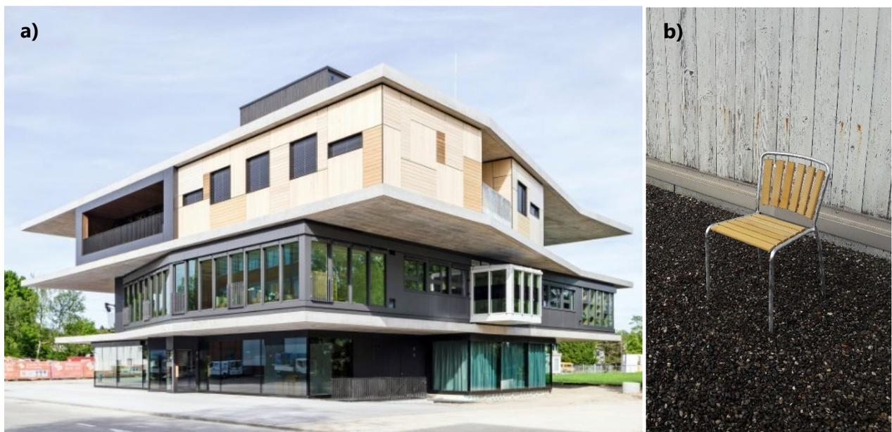
**Abbildung 8:** Freilandbewitterungstests der fertigmontierten Haefeli Stühle<sup>1020</sup> am Standort **a)** Empa, Dübendorf NEST und **b)** Dachterrasse am Standort Embru AG, Rüti.
