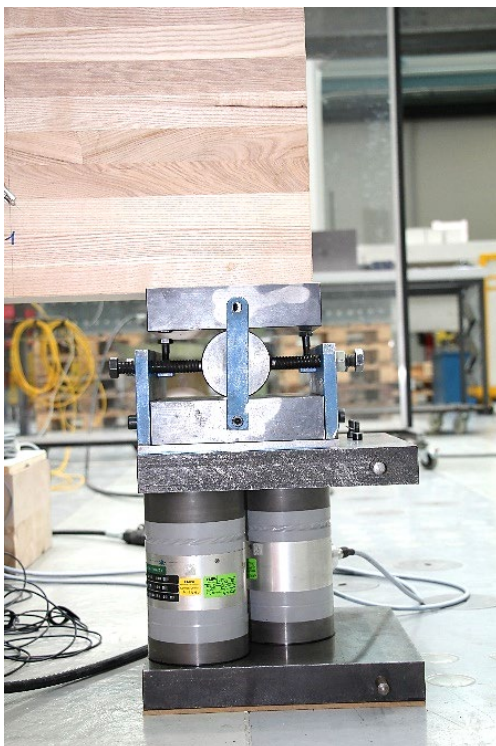
Abb. 7: Detailbild des Auflagers mit Kraftmessdosen.
