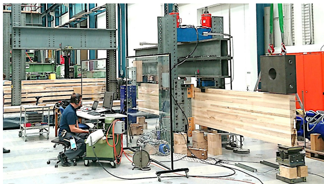
Abb. 2: Versuchsaufbau an der Empa für die 4-Punkt-Biegeversuche an Eschen-BSH: a) Versuchs-Typ ES-3.1 und ES-3.2; b) Versuchs-Typ 3.3.
