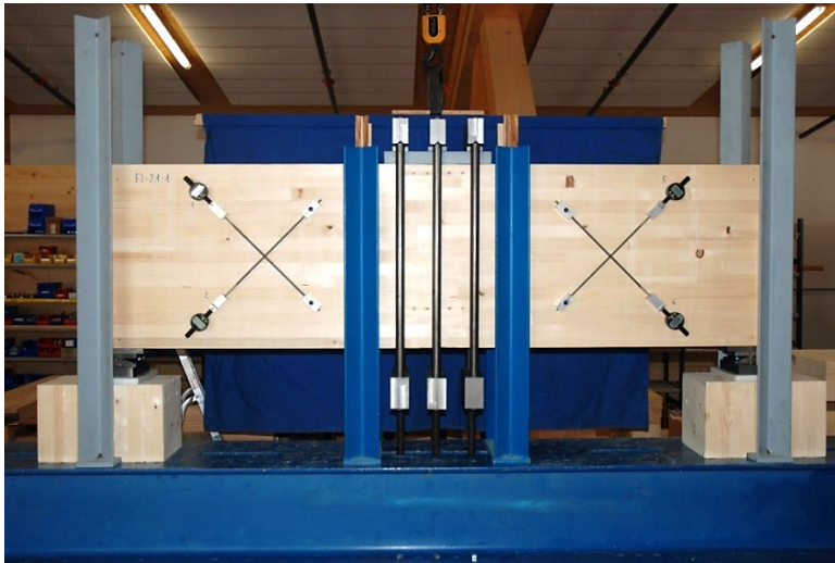
Abb. 8: Versuchsaufbau im Prüflabor der n'H für die 3-Punkt-Biegeversuche an Fichten-BSH.
