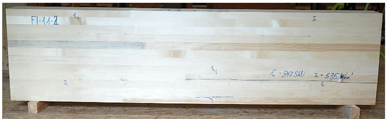
Abb. 10: Beispiel eines typischen Schubbruchs (Prüfkörper FI-1.1--2).
