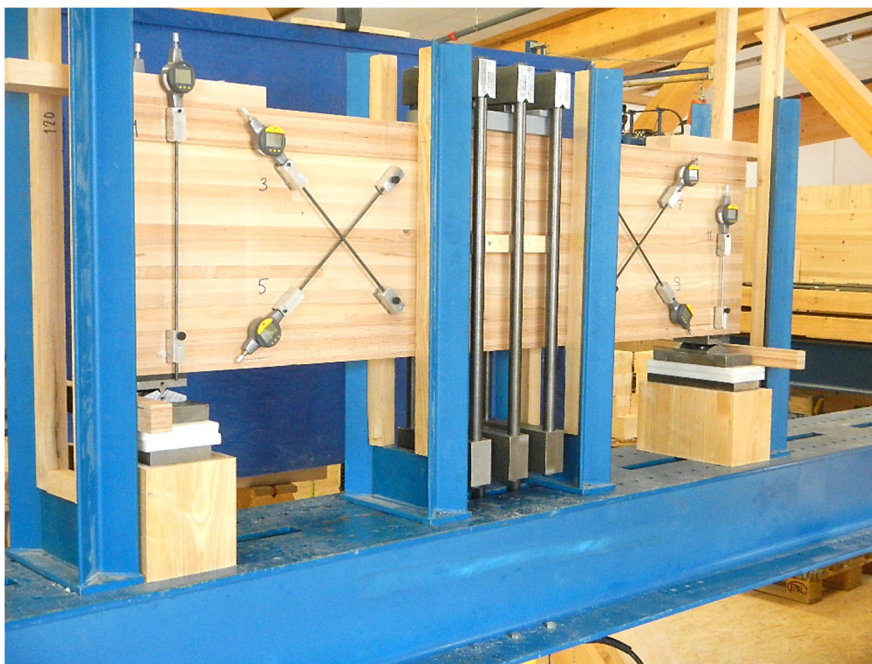
Abb. 9: Einer der höheren Träger im Prüfstand. Gut erkennbar sind die gekreuzt angeordneten Messsysteme zur Messung der Schubverzerrungen.
