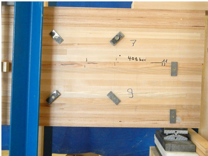
Abb. 17: Prüfkörper mit h = 500 \text{ mm} : Bruch bei einer vergleichsweise niedrigen Kraft von 583 \text{ kN} infolge geschwächter Klebfuge und nicht der Ziel-Festigkeitsklasse entsprechenden Brettlamelle auf halber Trägerhöhe.
