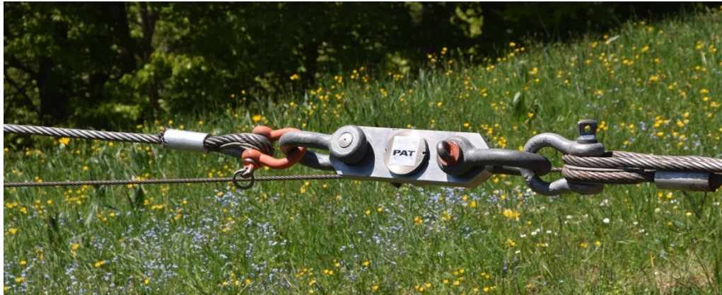
Abbildung 21: Kraftmessdose PAT beim Berganker der Seillinie Buriwand (Foto: Laura Ramstein).
