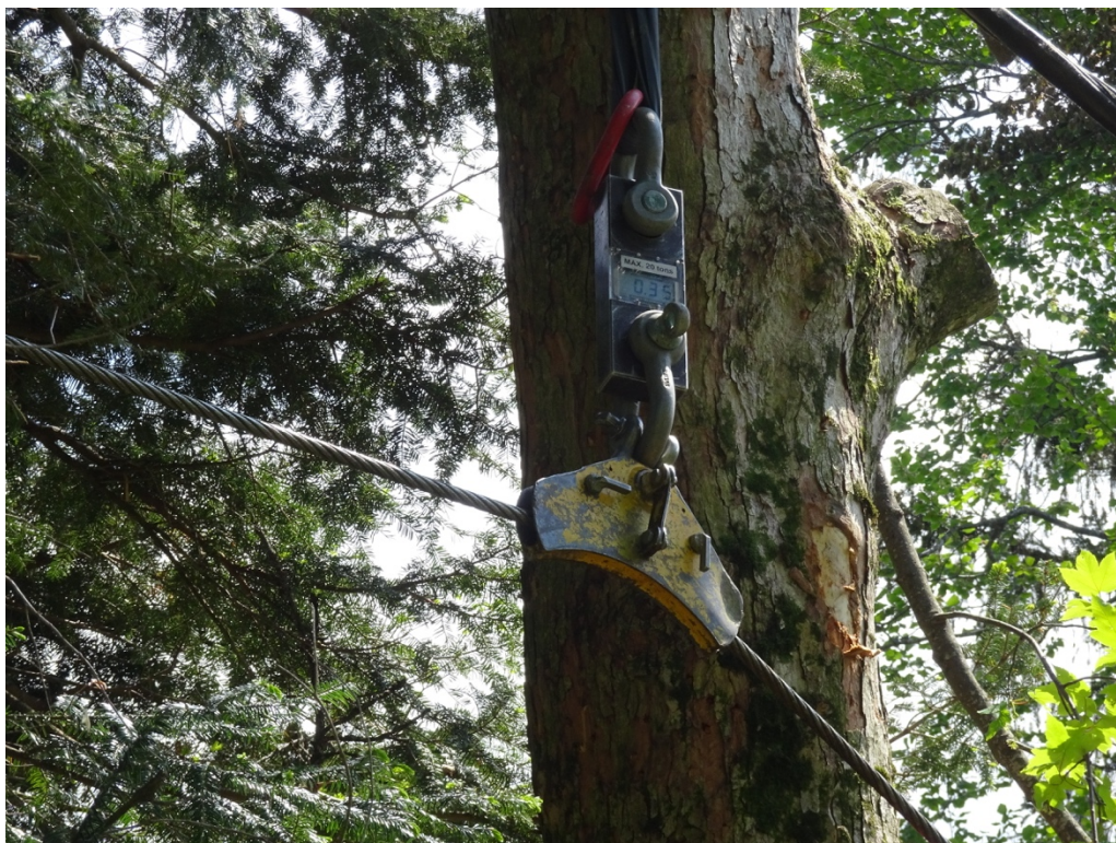
Abbildung 22: Kraftmessdose OMEGA TRIPLO beim Endmast der Seillinie Buriwand (Foto: Fritz Frutig)
