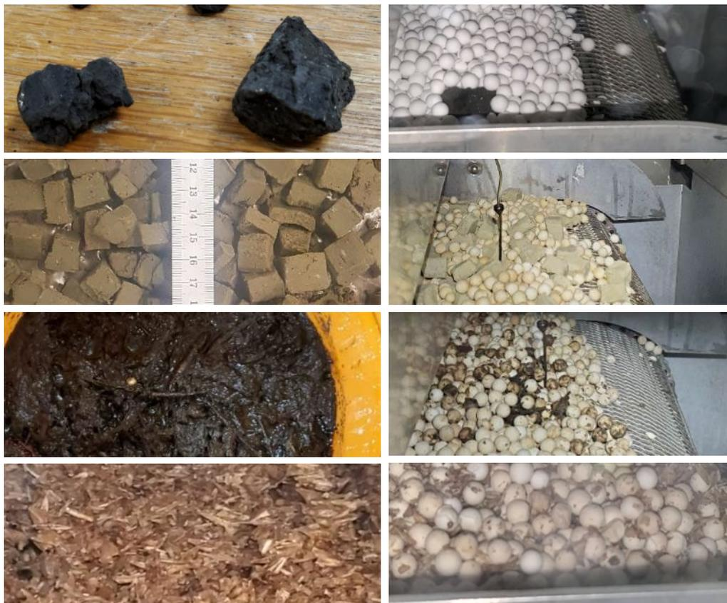
**Abbildung 29** Einblick in die Testtrocknungen von Biokohle, Ton, Gärresten und Biertreber mit Silikagel als Matrixmaterial in der Laboranlage «Triss»
