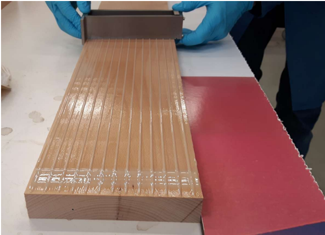
Bild 8: Klebstoffauftrag mit einem Rakel (links) und drei Probenteile (Lamellenpaare) in der Presse (rechts)
