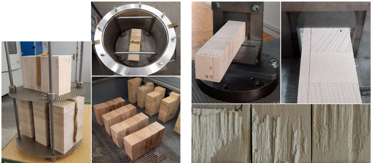
Bild 10: Prinzip der Delaminierungs- (links) und der Blockscher-Prüfung (rechts)
