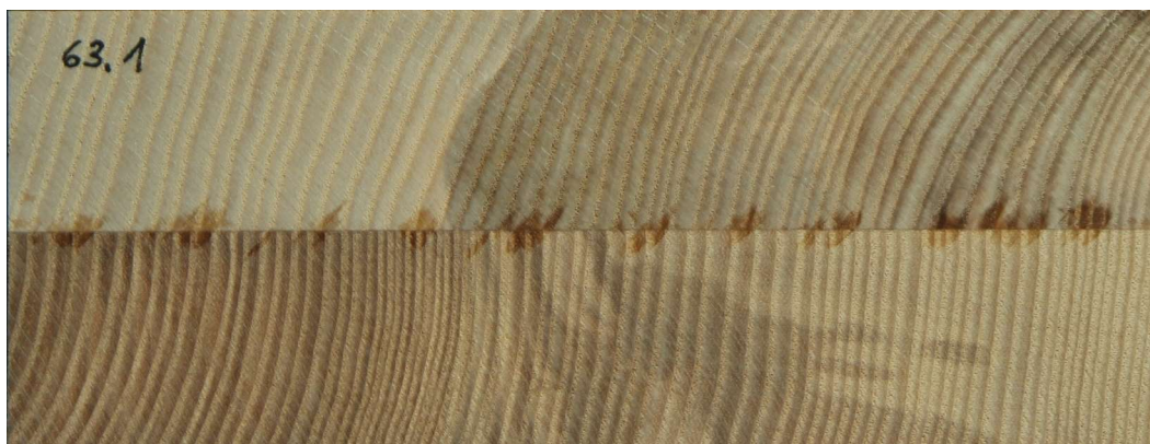
Bild 11: Querschnittsprobe mit angeschnittenen Bereichen zur Messung der Klebfugendicke
