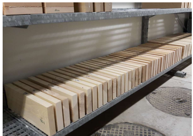
Bild 6: Rohlamellen in 3-fach Länge (links) und Lamellenabschnitte in der Konditionierung (rechts)
