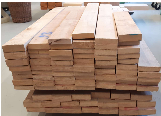
Bild 6: Rohlamellen in 3-fach Länge (links) und Lamellenabschnitte in der Konditionierung (rechts)
