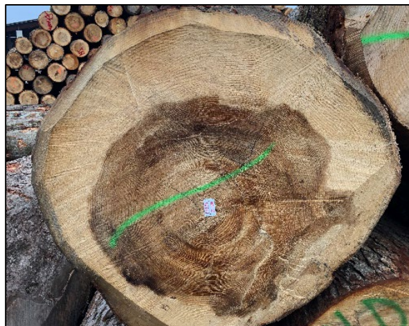
Abb. 4: Tannenrundholz mit gut sichtbarem, pathologischem Nasskern. Der Nasskern ist ungleichmässig über den Stammquerschnitt verteilt.
