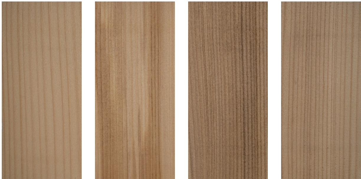
Abb. 5: Im Bericht berücksichtigte Varianten der Weisstanne ( abies alba ): von links Tanne normal, Tanne rotstreifig, Tanne mit normalem Nasskern, Tanne mit pathologischem Nasskern
