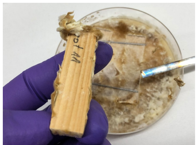
Abb. 12: rotstreifige Probe mit teilweise entferntem Dunkelfruchtkörper ohne sichtbare Schädigung der Holzsubstanz
