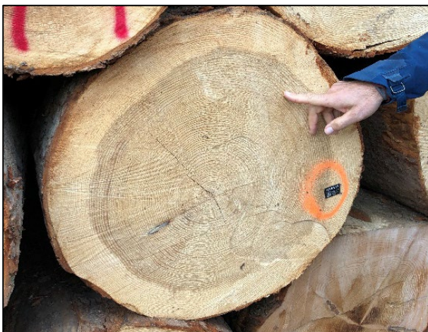
Abb. 3: Tannenrundholz mit gut sichtbarem, normalem Nasskern; er verläuft grösstenteils entlang der entsprechenden Jahrringgrenze.
