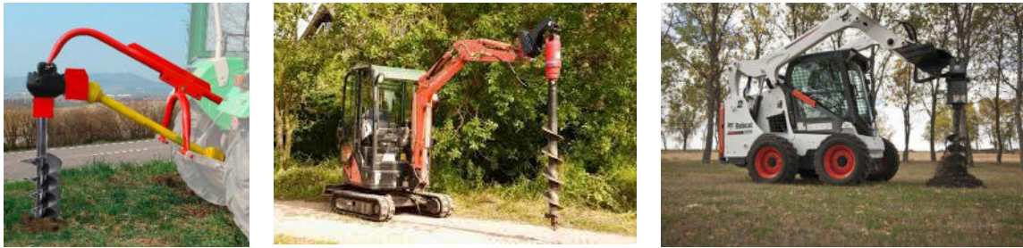
Abb. 9 Beispiele für Erdbohrer als Anbaugerät auf verschiedenen Trägerfahrzeugen
