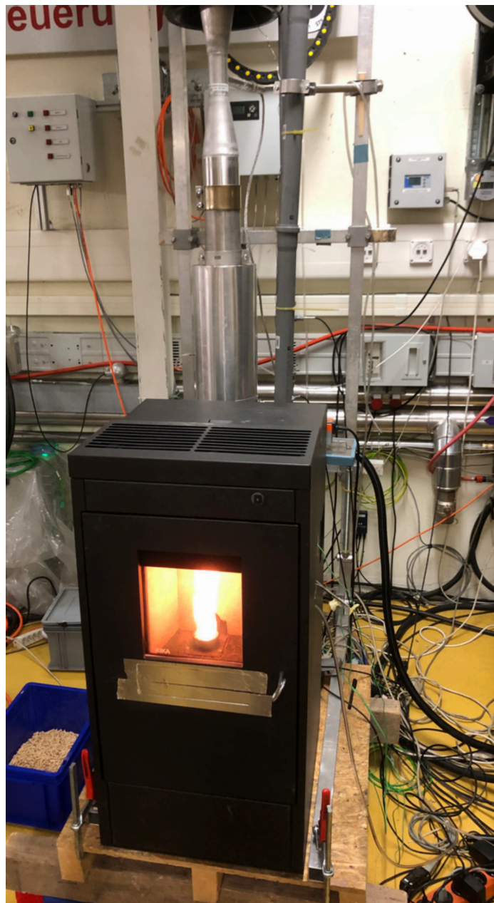
L'équipe de chercheurs de la FHNW a travaillé sur deux prototypes de poêles à pellets : Le premier a permis de tester le concept, tandis que le second (photo) est déjà orienté, dans son mode de construction, vers une future production en série. Photo : FHNW
