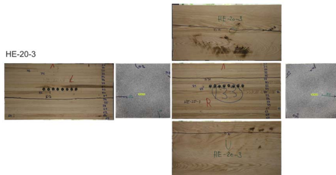
Abbildung 93: Schädigungsentwicklung in homogenen Escheproben mit 40,30,20mm Lamellen im Trockenschrank.
