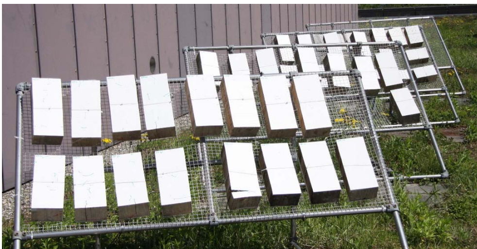
Abbildung 7: Proben auf den Bewitterungsprüfständen.
