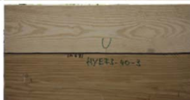
Abbildung 94: Schädigungsentwicklung in hybriden Fichte/Escheproben mit 40mm Lamellen im Trockenschrank.
