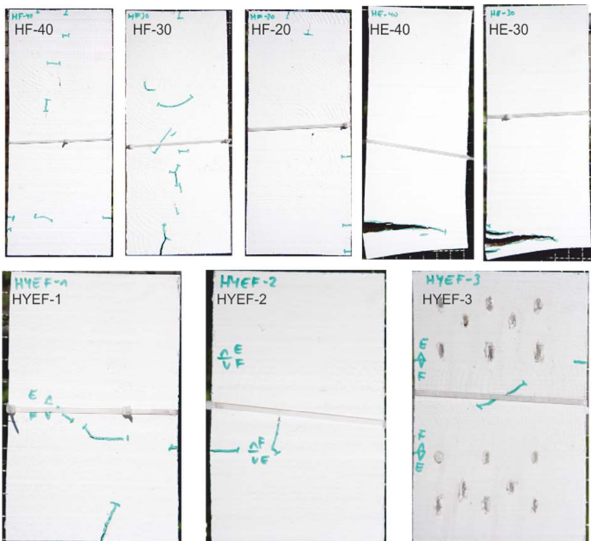
Abbildung 28: Beobachtete Schäden der Segmente im gewitterten Aussenlager.
