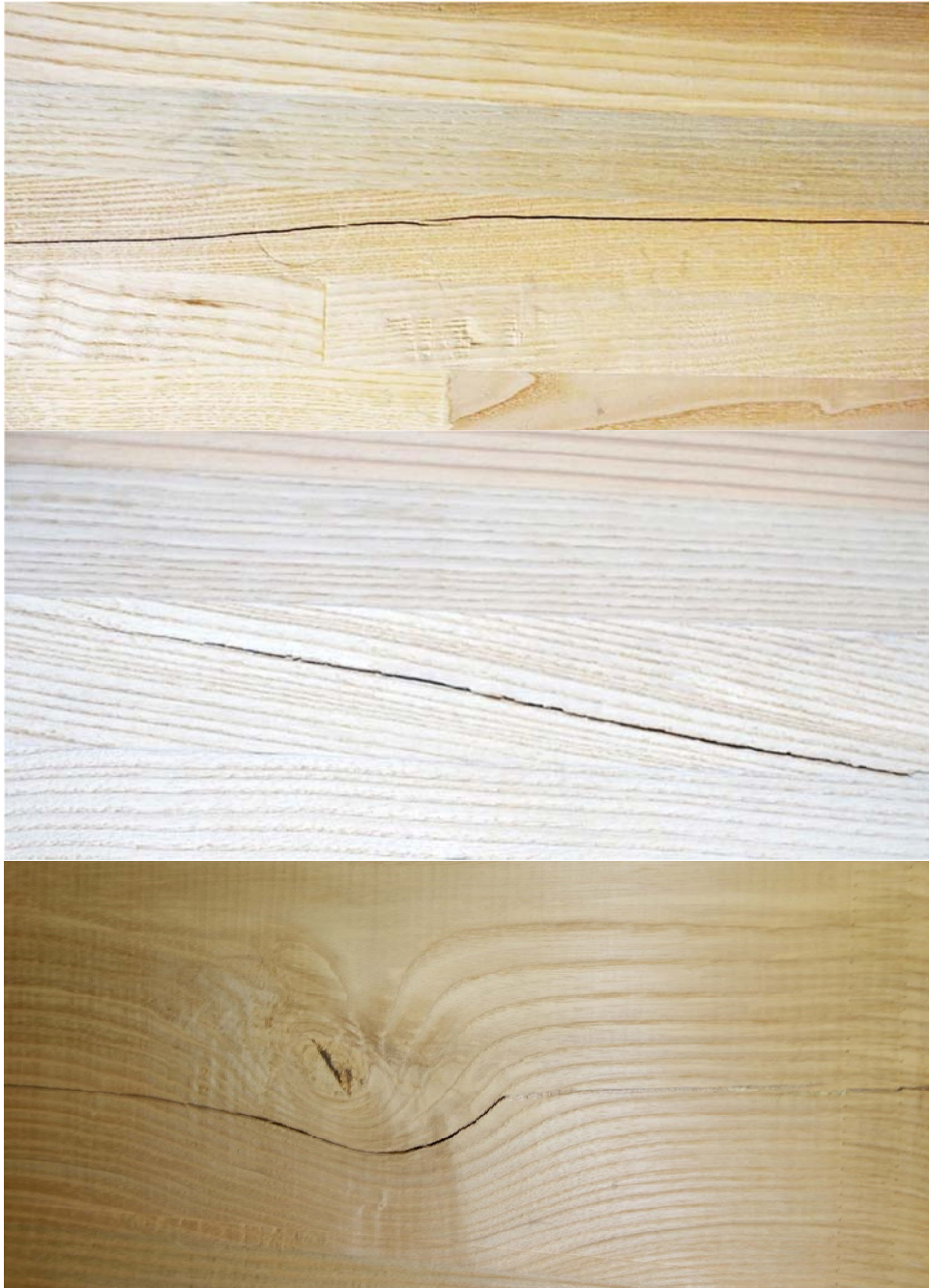
Abbildung 83: Einfluss Faser-Last-Winkel, dadurch Holzbruch in Esche (oben und mittig), sowie Fichte
