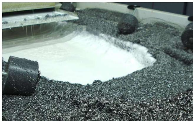
Abbildung 17: Bandfilteranlage zur Abtrennung der Metallspäne vom zu rezirkulierenden Kühlschmiermittel (APODIS GmbH)
