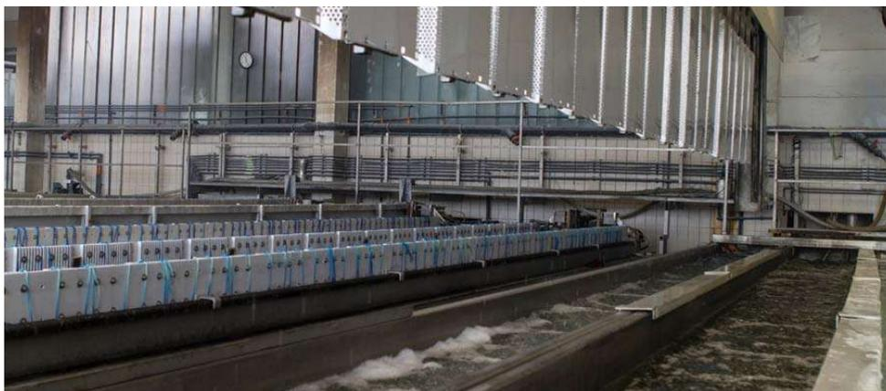
Abbildung 12: Beizen von Aluminiumblechen im Tauchverfahren (ESP Südexal GmbH)
