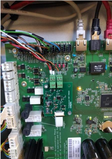
Abbildung 25: Treiberboard zur Ansteuerung der KNF FMM20 Pumpe.
