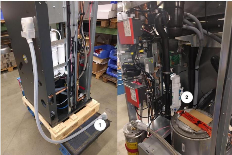
Abbildung 34: Links: Feldtestgerät mit AquaStop an Rückwand montiert. Rechts: Umkehrosmose zur Vorreinigung des Leitungswassers.
