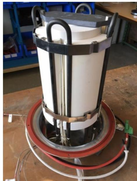
Abbildung 17 Aufbau Hexis Stackmodul mit Reformersmodul der Firma Bosal
