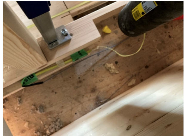
Abbildung 31: Sensorbänder mit grauem Verbindungskabel zur Auswertereinheit
