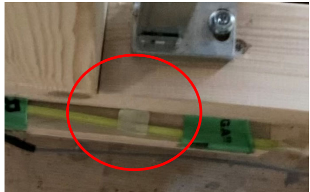
Abbildung 37: Reparatur von beschädigten Sensorbändern mit Klebeband
