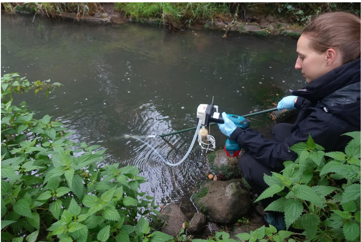
Abb. 5: Mit der VigiDNA pump wurde während zwei Mal 30 Minuten jeweils zirka ein Liter Wasser pro Minute aus dem Gewässer entnommen und über den Filter laufen gelassen.
