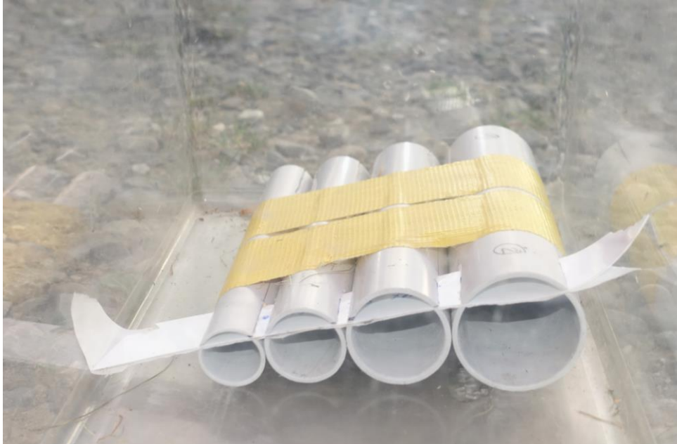
Abb. 1: Serie von Plastikröhren mit unterschiedlichen Durchmessern und einem Klebestreifen (weiss im Vordergrund), an welchem die Haare kleben bleiben.
