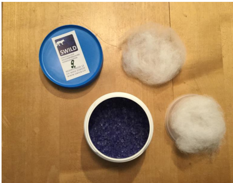
Abb. 3: Der Sammelbehälter für Kotproben, mit Sila Blaugelkugeln und zwei Schichten Füllmaterial zur Einbettung der Proben. Dies ermöglicht eine schnelle Austrocknung der Proben und die lichtgeschützte Lagerung.
