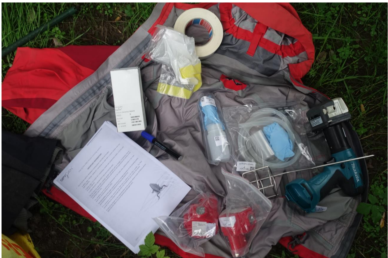
Abb. 4: Das VigiDNA tubing sampling kit mit einer mobilen, akkubetriebenen Wasserpumpe, Filter und Puffer zur Lagerung der Proben.
