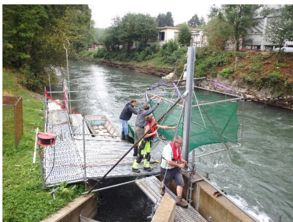
Mise en place du piège à la grue (Aquarius)
