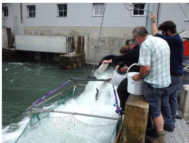
Relâche des poissons marqués dans un haveneau (à gauche) et dans un exutoire de dévalaison (à droite) (Aquarius)
