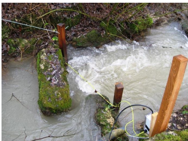
Installation d'une antenne dans un ruisseau de contournement (AquaPlus)
