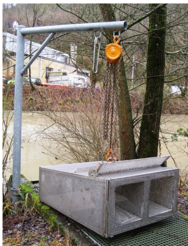
Nasse de type cage en tôle perforée avec système de levage (potence et palan) (AquaPlus)
