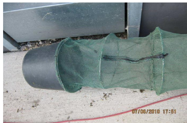
Cage avec haveneau, verveux, seau et fermeture éclair pour accéder aux poissons (Schmalz 2010)
