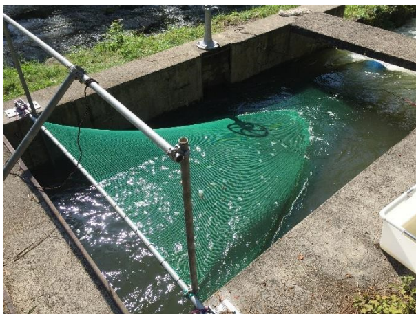
Haveneau et baril de collecte ; système amovible et rabattable sous le filet (AquaPlus)
