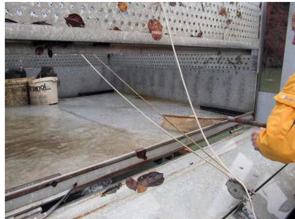
Vidange de la cage par basculement de la paroi latérale de la cuve (Fischwerk)
