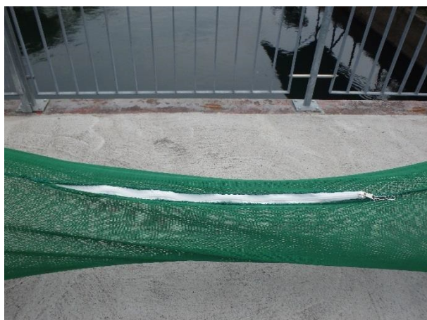
Fermeture éclair pour récupération rapide des poissons et des flottants (Aquarius)
