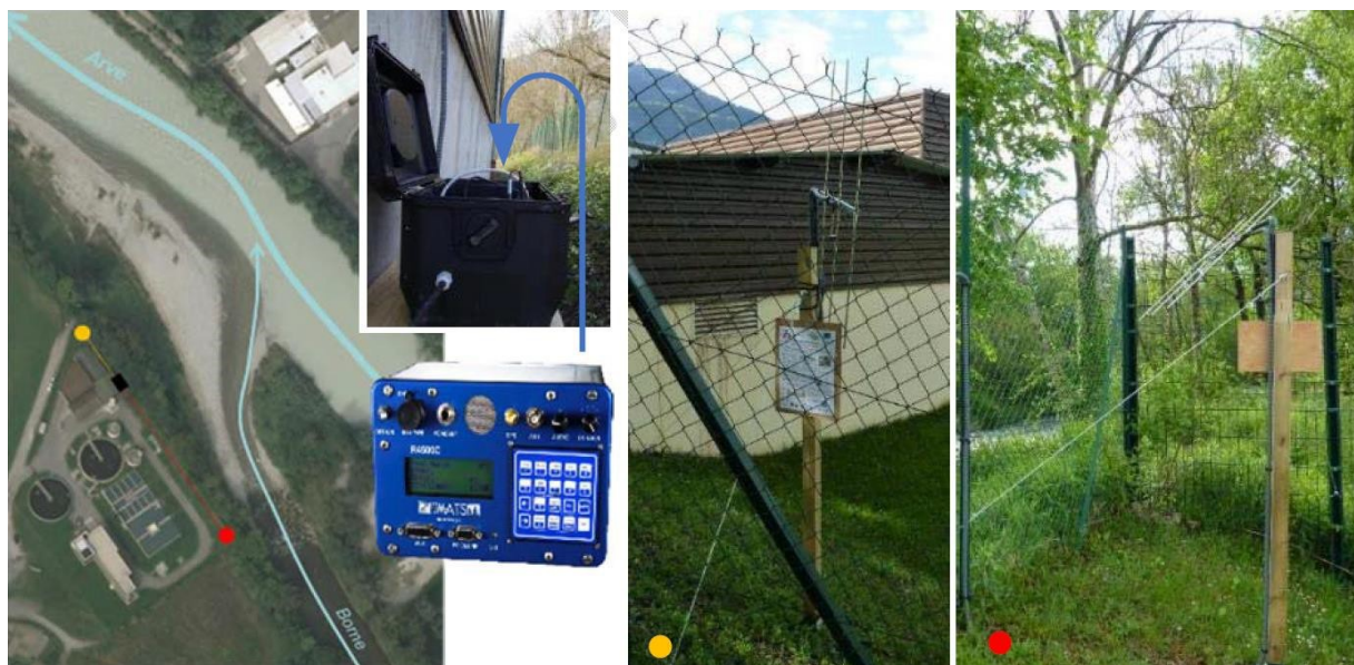
Exemple d'antennes fixes utilisées dans un suivi radiotéléométrique dans l'Arve et le Rhône (Beaufils & al., in prep.)
