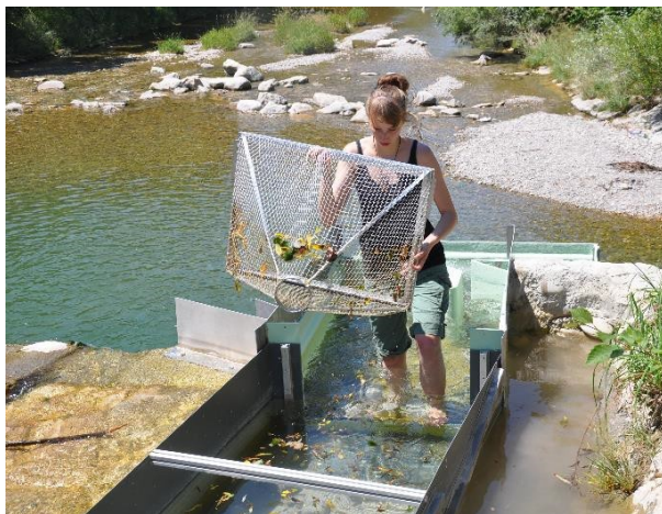
Mise en place de la grille inférieure dans la passe (Baier)
