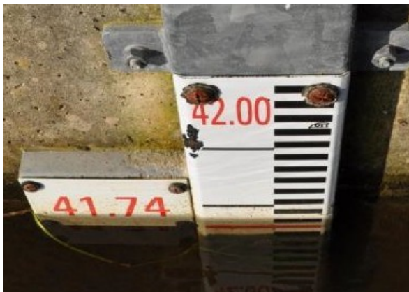
Fig. 5: Les repères ou toises installés sur les parois facilitent le contrôle de certains paramètres. À l'occasion de vidanges périodiques, l'état de l'ouvrage peut être contrôlé dans sa totalité. (Aquarius)
