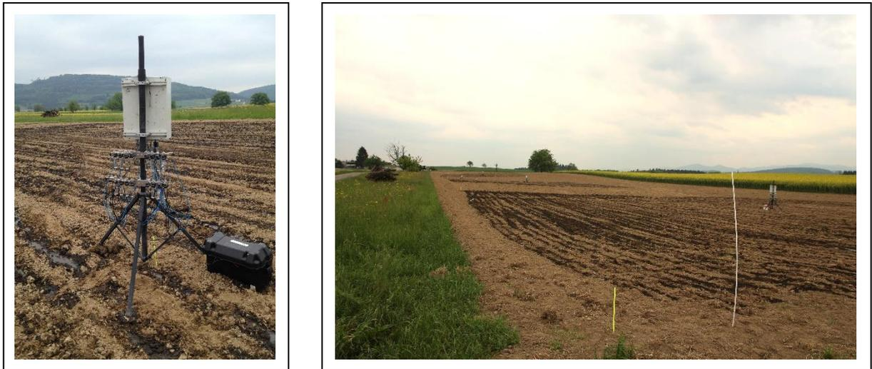
Abbildung 7: Probenahme für die  $\text{NH}_3$ -Messung mit automatisiertem Säurefallensystem.
