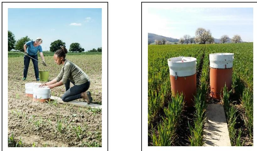
Abbildung 6: Probenahme für die Gasmessung im Mais 2018 (links, © Marion Nitsch) und im Winterweizen mit erweiterten Kammern (rechts).
