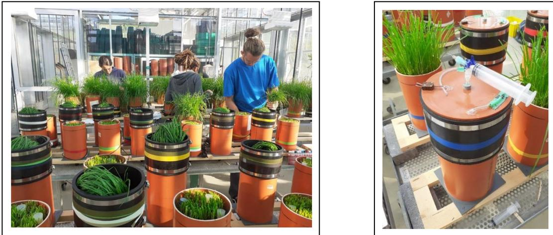
Abbildung 8: Säulensystem während dem Versuch (links) und geschlossene Säule mit Haube zur Gasmessung (rechts).
