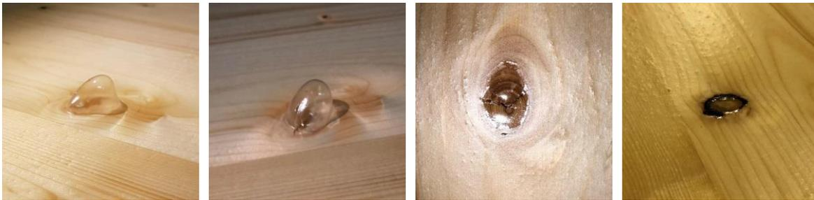
Figure 31. Apparition de bulle dans la couche primaire et manque d'adhésion aux nœuds du bois.
