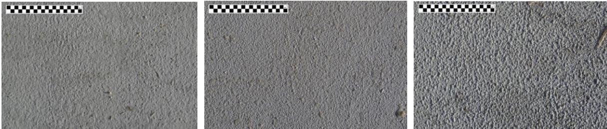
Figure 29. Revêtement PMMA avec granulométrie fine, moyenne et grossière.
