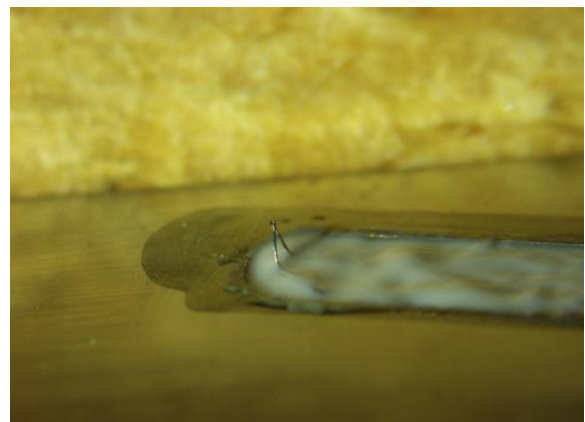
Abb. 30 Thermoelement-Schweisstellen (links: Oberflächenmessung, rechts Fluidmessung)
