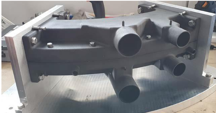
Abb. 11 Erste Version der zweigeteilten Statorbaugruppe mit Zu- und Abführungen für die Fluidströme
