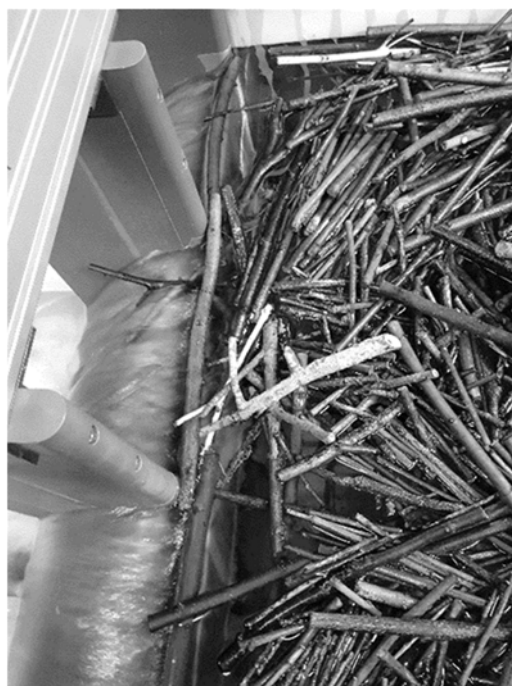
Figure 28. Exemple d'un tronc perpendiculaire (au déversoir) qui bloque le tapis de bois flottants.
