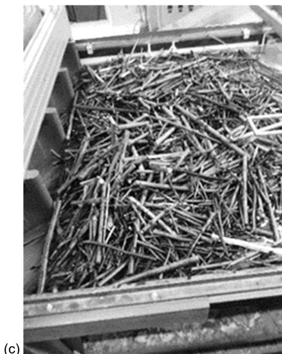
Figure 39. Effet de la largeur des passes ; (a) test 33 ( b/L_M=0.40 ), (b) test 15 ( b/L_M=0.60 ) et (c) test 24 ( b/L_M=0.77 ).
