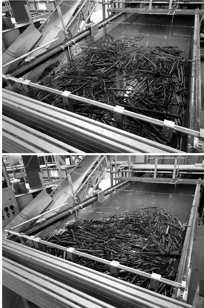
Figure 32. Vue de l'ensemble du volume de bois flottants depuis l'aval. (a) \chi \approx 0.33 : les bois flottants les plus en amont sont peu mobilisés par l'écoulement et (b) \chi \approx 1 : les bois flottants les plus à l'arrière sont mobilisés et s'approchent du râtelier.
