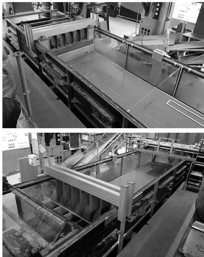
Figure 13. Vues depuis (a) l'amont et (b) l'aval du canal avec le déversoir à l'extrémité en aval, montrant l'une des configurations testées.
