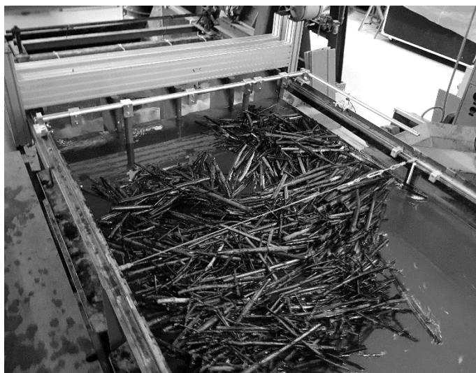
Figure 21. Illustration d'effets de modèle. Les troncs s'appuient sur la paroi de gauche formant un « effet d'arc » et s'orientent dans le sens des parois.
